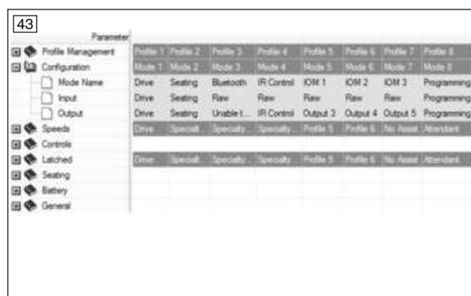
Dans les réglages d'origine, le mode IR Control configuré est le mode 4. Si cette programmation a été écrasée, il peut s'avérer nécessaire de réinitialiser la programmation indiquée ici. Une réinitialisation de la programmation est requise lorsqu'aucun accès au menu utilisateur IR n'est possible après l'apprentissage de codes IR.
