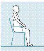
Existindo uma posição de sedestação por mais de dois segundos, isto é, a coxa está próxima da horizontal e não há carga sobre a perna, a articulação de joelho comuta a resistência para o mínimo no sentido de extensão.
