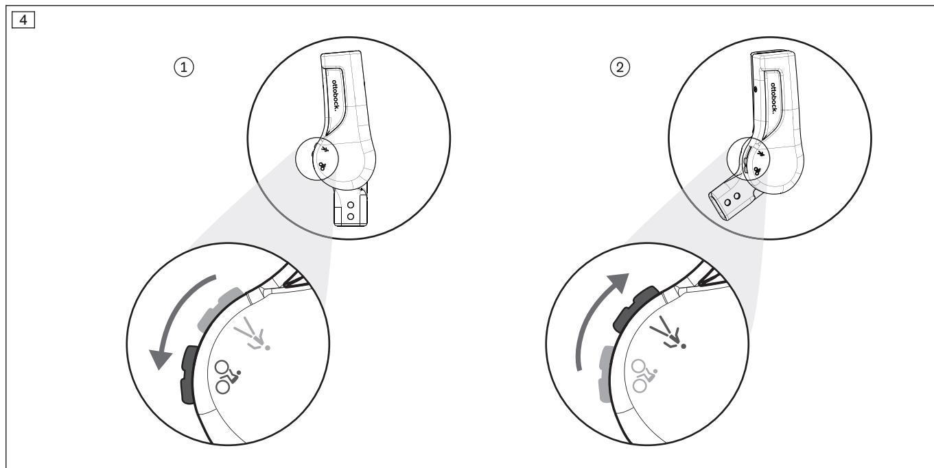
För speciella tillfällen (t.ex. cykling) kan det vara lämpligt att låsa upp ortosknäleden tillfälligt. Den mekaniska upplåsningen av ortosknäleden symboliseras av en person som cyklar (brytaren på "♂").
