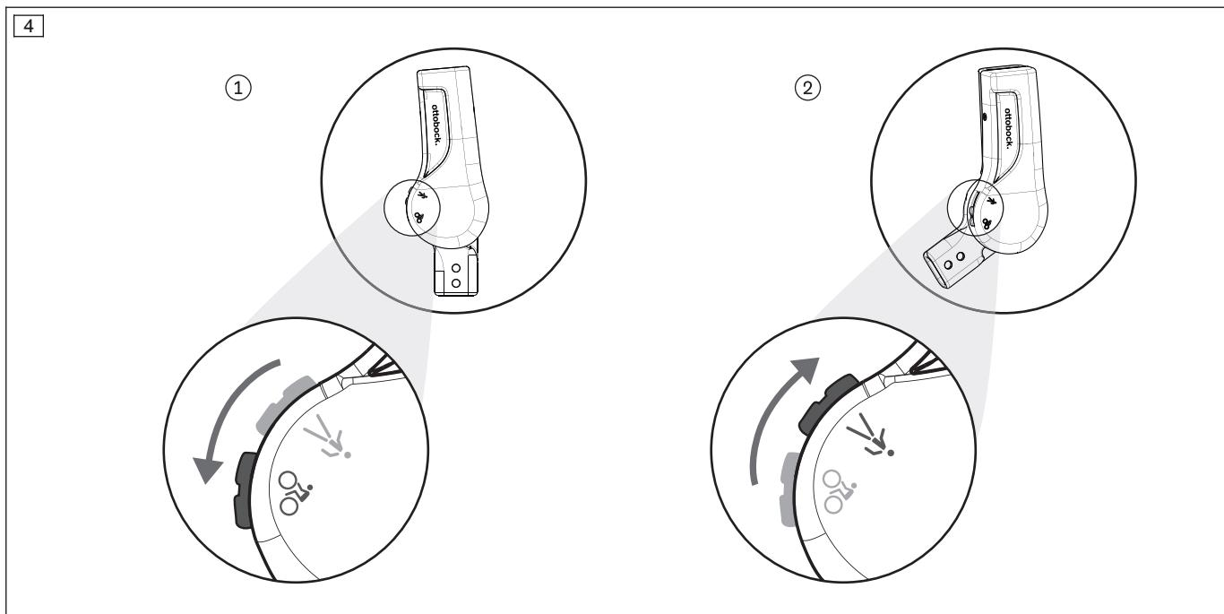
Für besondere Gelegenheiten (z. B. Fahrradfahren) kann es sinnvoll sein, dass Orthesenkniegelenk temporär zu entriegeln. Die mechanische Entriegelung des Orthesenkniegelenks wird durch die fahrradfahrende Person symbolisiert (Schalter auf „
