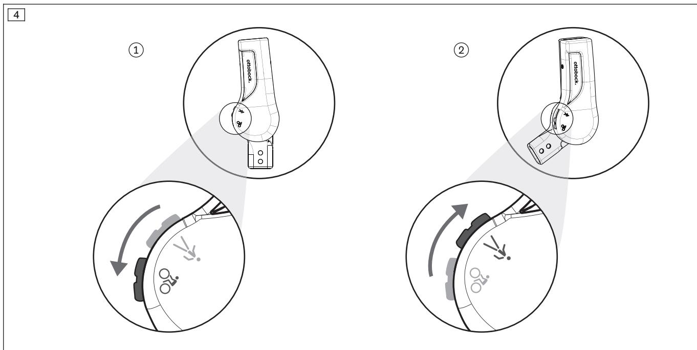
Voor bepaalde activiteiten (bijv. fietsen) kan het zinvol zijn het orthese kniescharnier tijdelijk te ontgrendelen. Dat het orthese kniescharnier mechanisch ontgrendeld is, wordt gesymboliseerd door de fietser (schakelaar op "♂").
