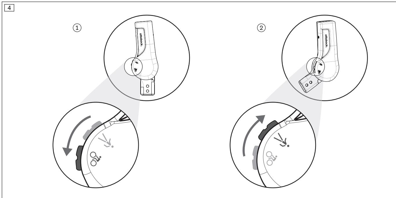
En ocasiones especiales (p. ej., al montar en bicicleta) puede ser útil desbloquear de forma temporal la articulación de rodilla ortésica. El desbloqueo mecánico de la articulación de rodilla ortésica se indica con el símbolo de un ciclista (interruptor en "♂").
