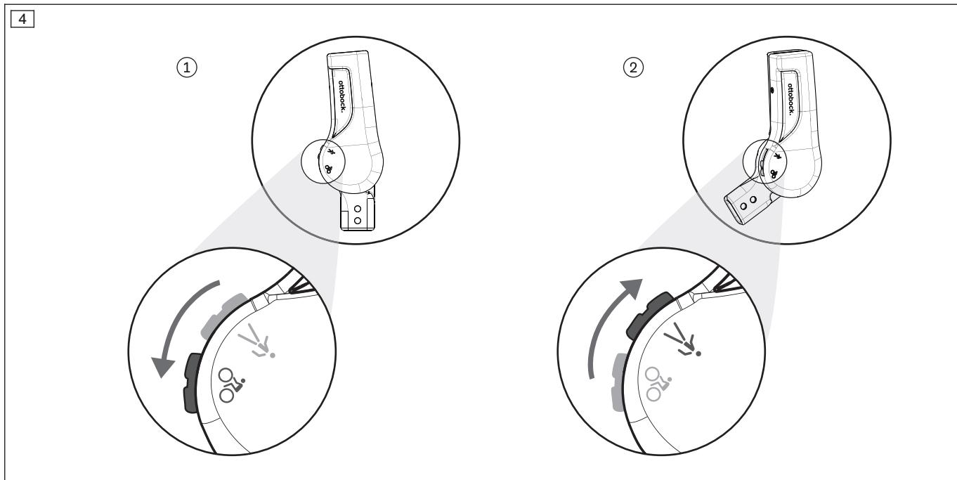
В особых ситуациях (например, при езде на велосипеде) может оказаться полезным временно разблокировать коленный узел ортеза E-MAG Active. Механическая разблокировка коленного узла ортеза обозначена значком "Велосипедист" (переключатель на "велосипедист").
