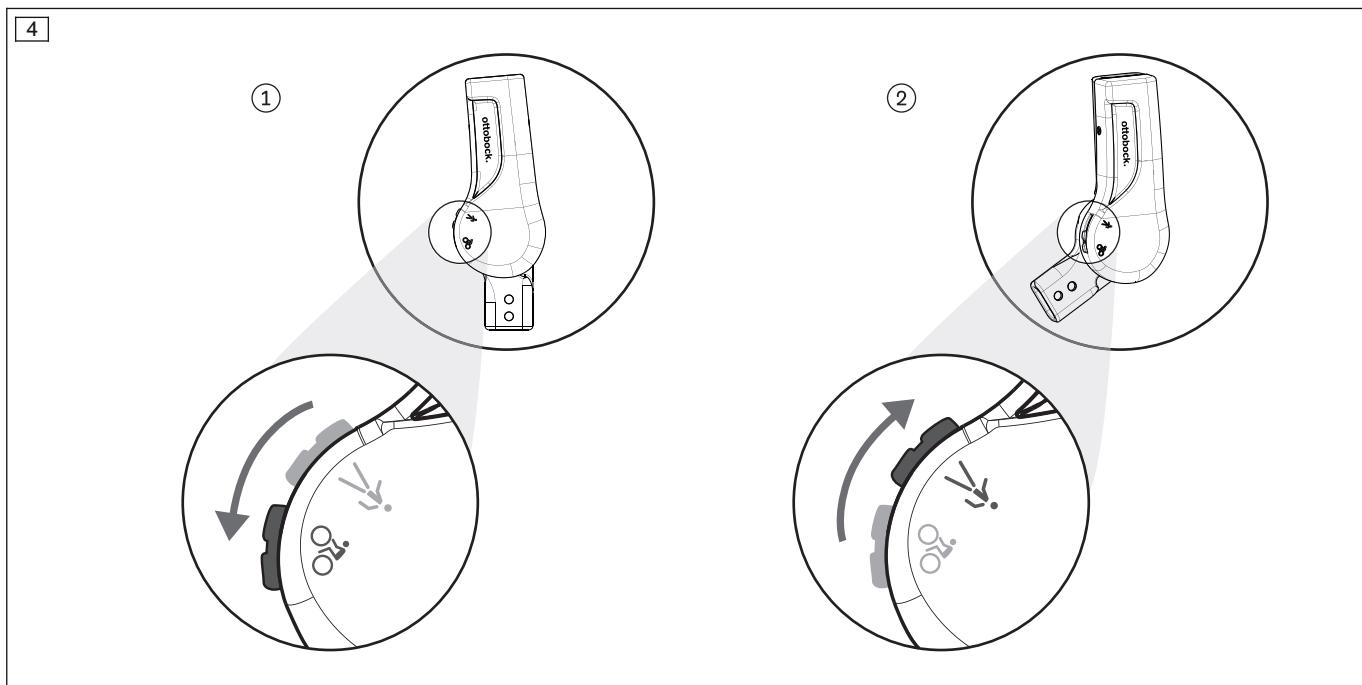
对于特殊情形（例如骑自行车），将矫形器膝关节暂时解锁可能会有帮助。骑自行车的小人符号表示矫形器膝关节已机械解锁（开关位于“
