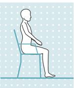
Liegt für länger als zwei Sekunden eine Sitzposition vor, d. h. der Oberschenkel ist annähernd waagrecht und das Bein unbelastet, schaltet das Kniegelenk den Widerstand in Streckrichtung auf ein Minimum.
