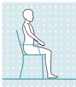
Na posição de sedestação, ou seja, com a coxa próxima da horizontal e sem carga sobre o membro inferior, a articulação de joelho comuta para uma baixa resistência tanto no sentido de flexão como no de extensão.
