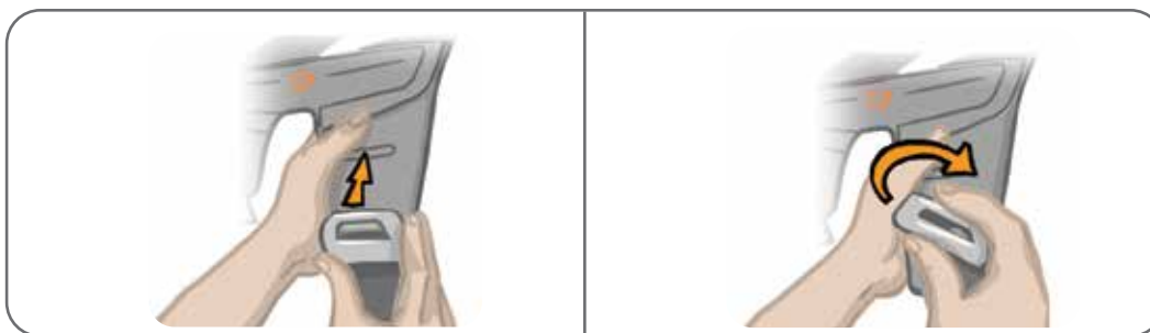
Obrázek 11-13: Opětovné připojení popruhů pro stehno
