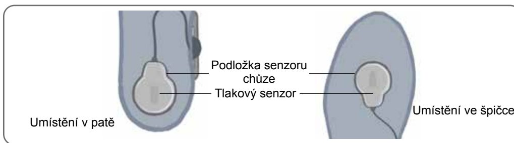
Obrázek 8-13: Umístění nožního snímače v botě
