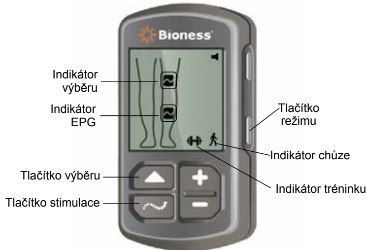
Obrázek 4-8: Výběr provozního režimu pomocí řídicí jednotky
