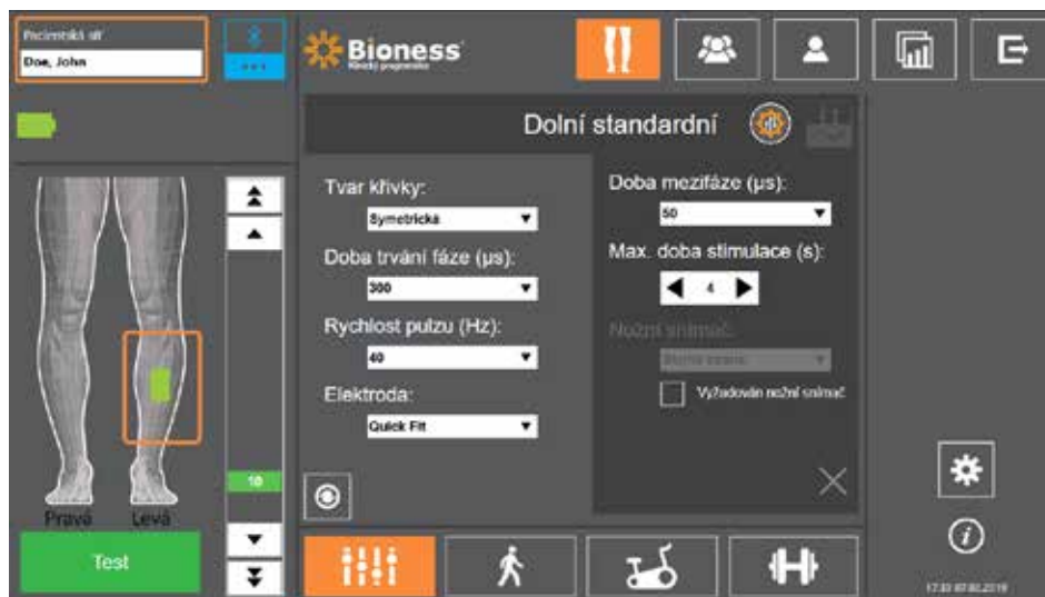
Obrázek 9-4: Programování stimulace, obrazovka parametru s oknem rozšířených nastavení
