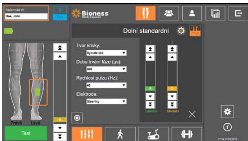
Obrázek 7-7: Obrazovka parametru se zobrazenými rozšířenými parametry
