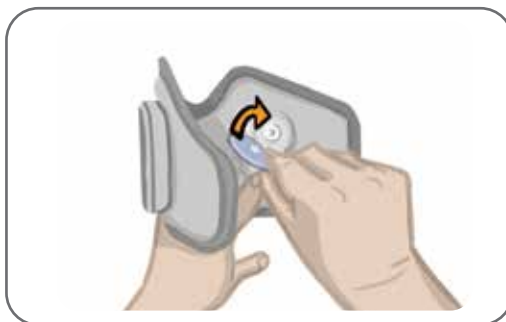
Obrázek 11-6: Připojení kruhových textilních elektrod
