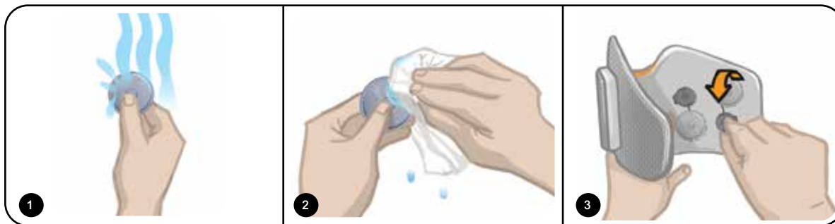
Obrázek 8-11: Upevnění kruhové textilní elektrody
