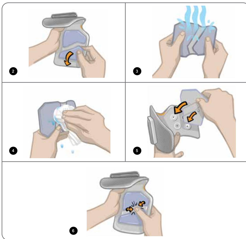
Obrázek 11-3: Výměna rychle uchytitelné elektrody
