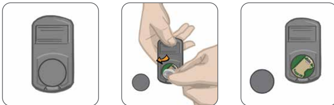
Obrázek 11-2: Výměna baterie řídicí jednotky
