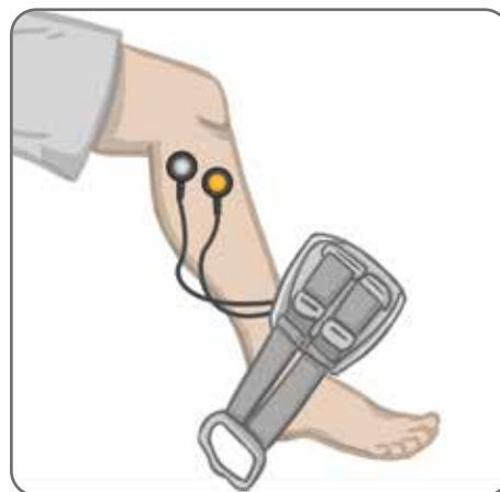
Afbeelding 6-6: Fittingkabel bevestigd aan de onderbeenmanchet en elektrodehouders
