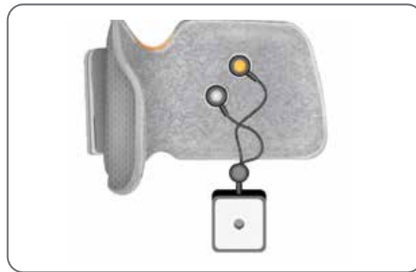
Afbeelding 12-1: Testapparaat aangesloten op de onderbeenmanchet
