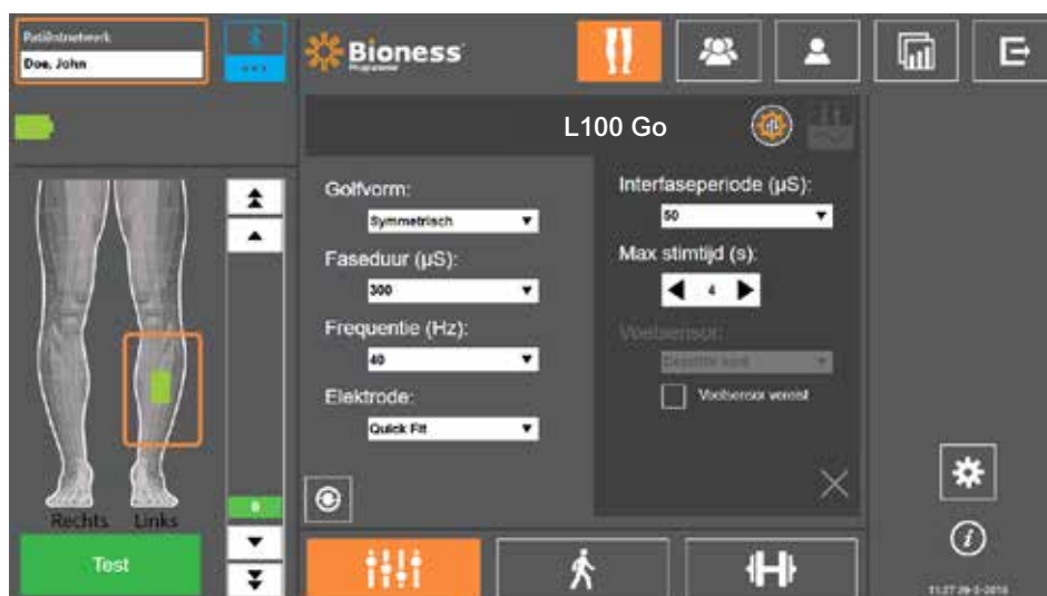
Afbeelding 9-4: Stimulatie programmeren, Parameterscherm met venster Geavanceerde instellingen
