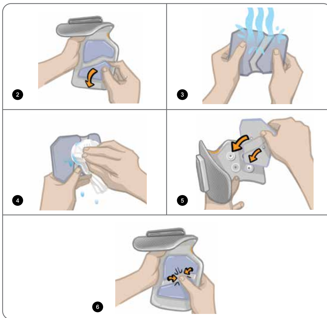
Figure 11-1 : Remplacement de l'électrode à installation rapide
