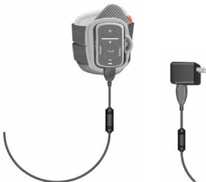
Figure 4-7 : Configuration du chargement du système L100 Go
