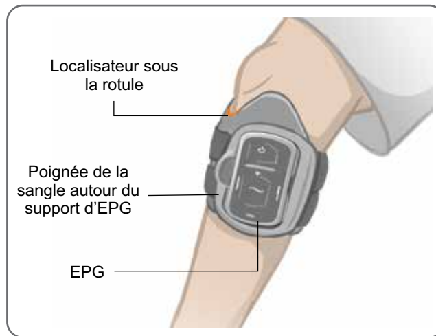
Figure 8-8 : Retrait de la jambièrè avec bases d'électrodes captives
