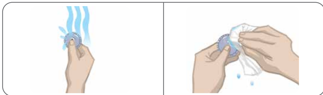
Afbeelding 6-5: De elektrode natmaken en overtollig water verwijderen
