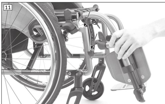
**Retrait des repose-pieds – repose-pieds avec support repose-pieds pour Avantgarde DF Version V**
