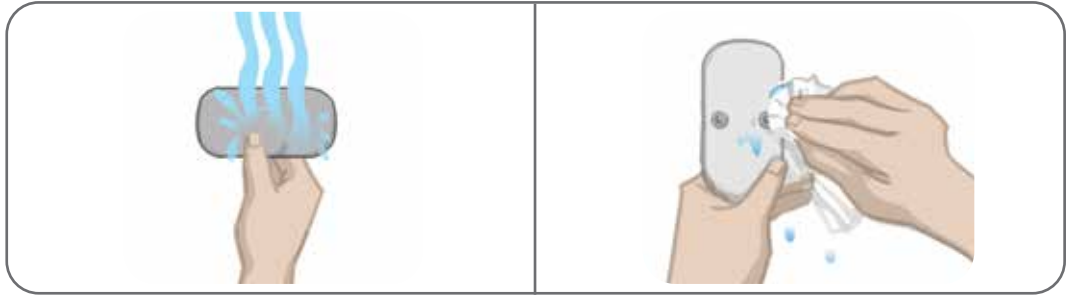
Afbeelding 6-9: De elektrode natmaken en overtollig water verwijderen
