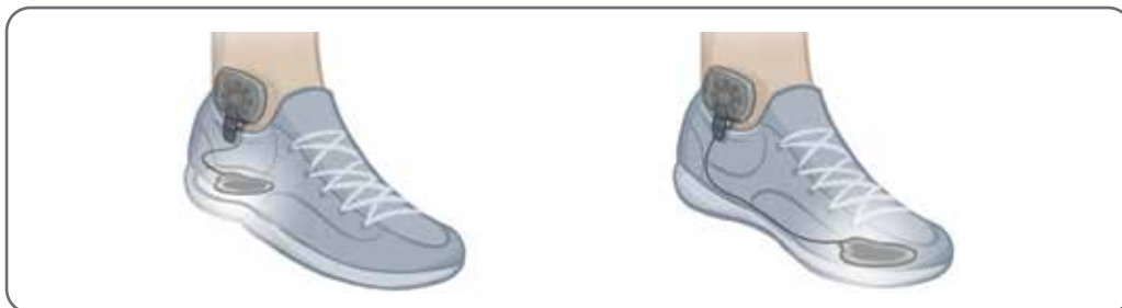
Afbeelding 6-19: Positie van de voetsensor bevestigd aan de schoen
