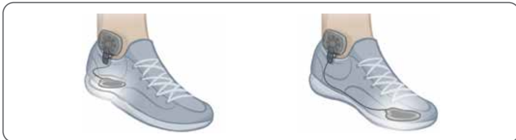
Figura 6-19: Posizione finale del sensore piede attaccato alla scarpa.
