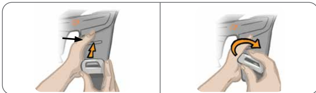
Figura 8-13: Rimozione delle fasce per coscia
