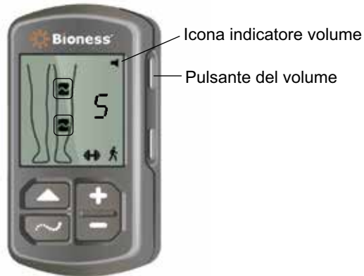
Figura 7-3: Pulsante del volume sull'unità di controllo
