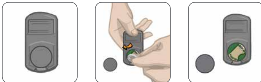
Figura 8-2: Sostituzione della batteria dell'unità di controllo
