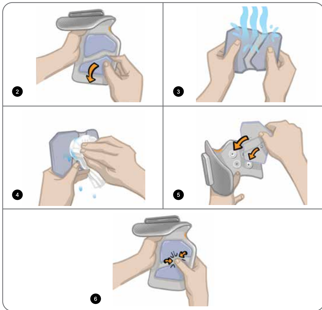
Figura 8-3: Sostituzione dell'elettrodo Quick Fit
