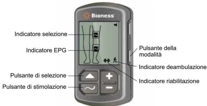
Figura 7-1: Selezione di una modalità operativa sull'unità di controllo
