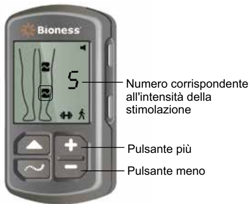
Figura 7-2: Regolazione dell'intensità della stimolazione
