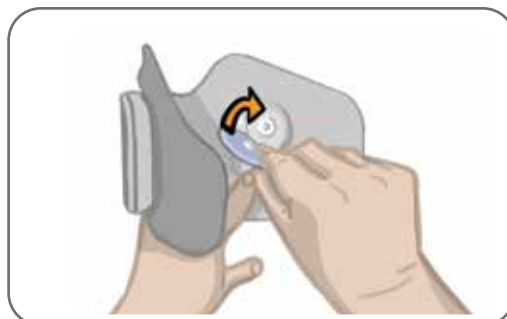
Abbildung 6-6: Befestigen der runden Gewebeelektroden
