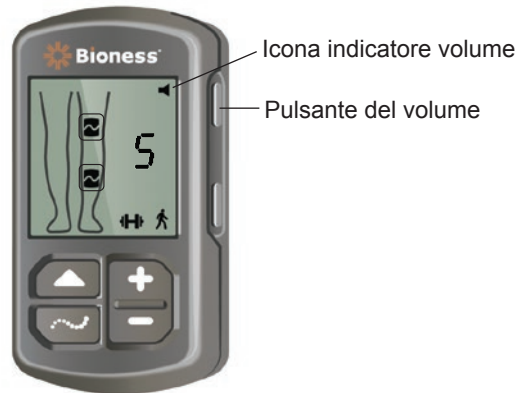
Figura 4-10: Pulsante del volume sull'unità di controllo
