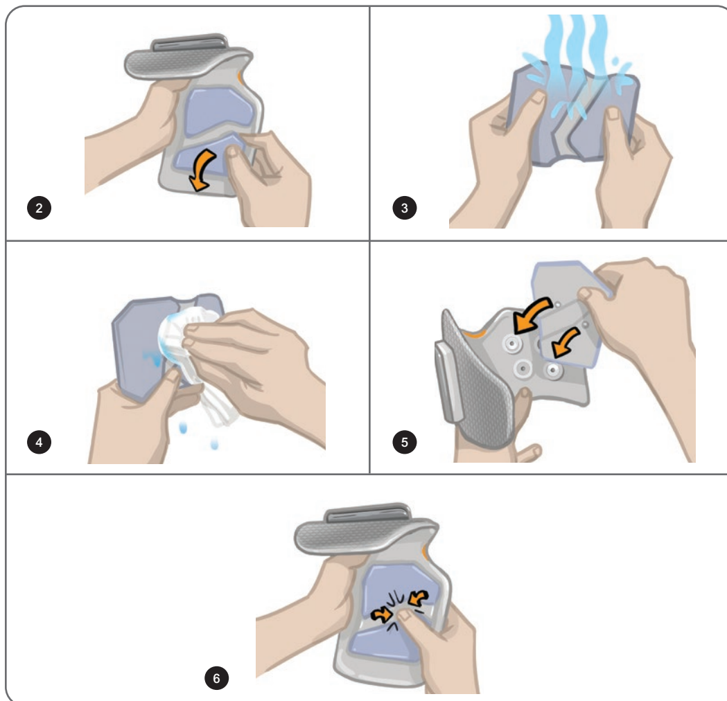
Figura 11-3: Sostituzione dell'elettrodo Quick Fit
