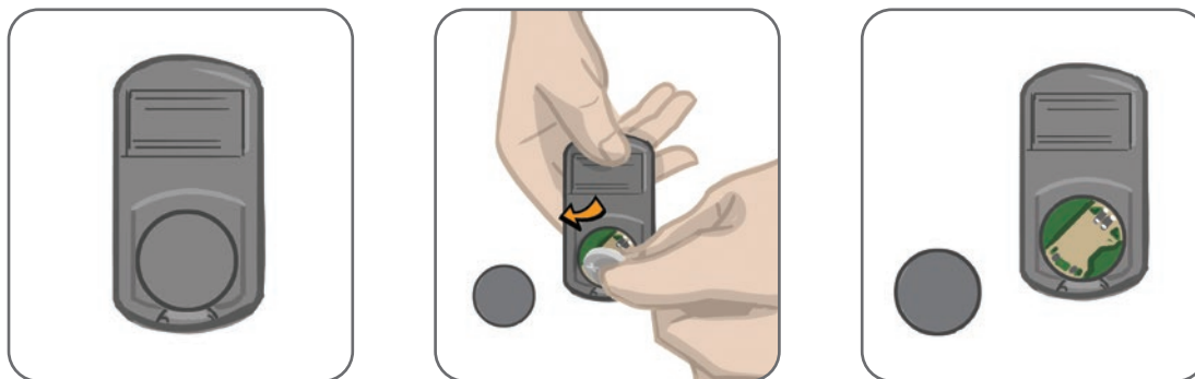
Figura 11-2: Sostituzione della batteria dell'unità di controllo
