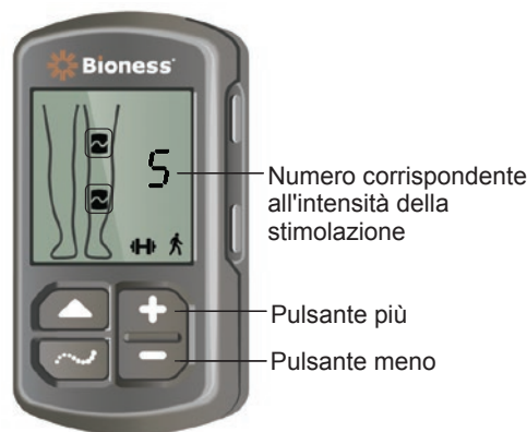
Figura 4-9: Regolazione dell'intensità della stimolazione
