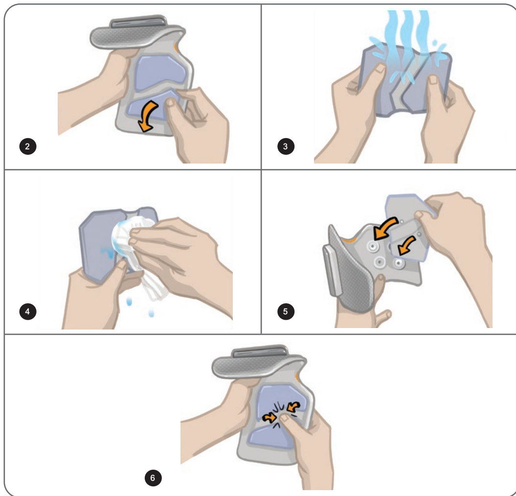
Figura 8-3: Înlocuirea electrodului cu fixare rapidă
