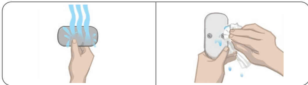
Figura 6-9: Umezirea electrodului și îndepărtarea excesului de apă
