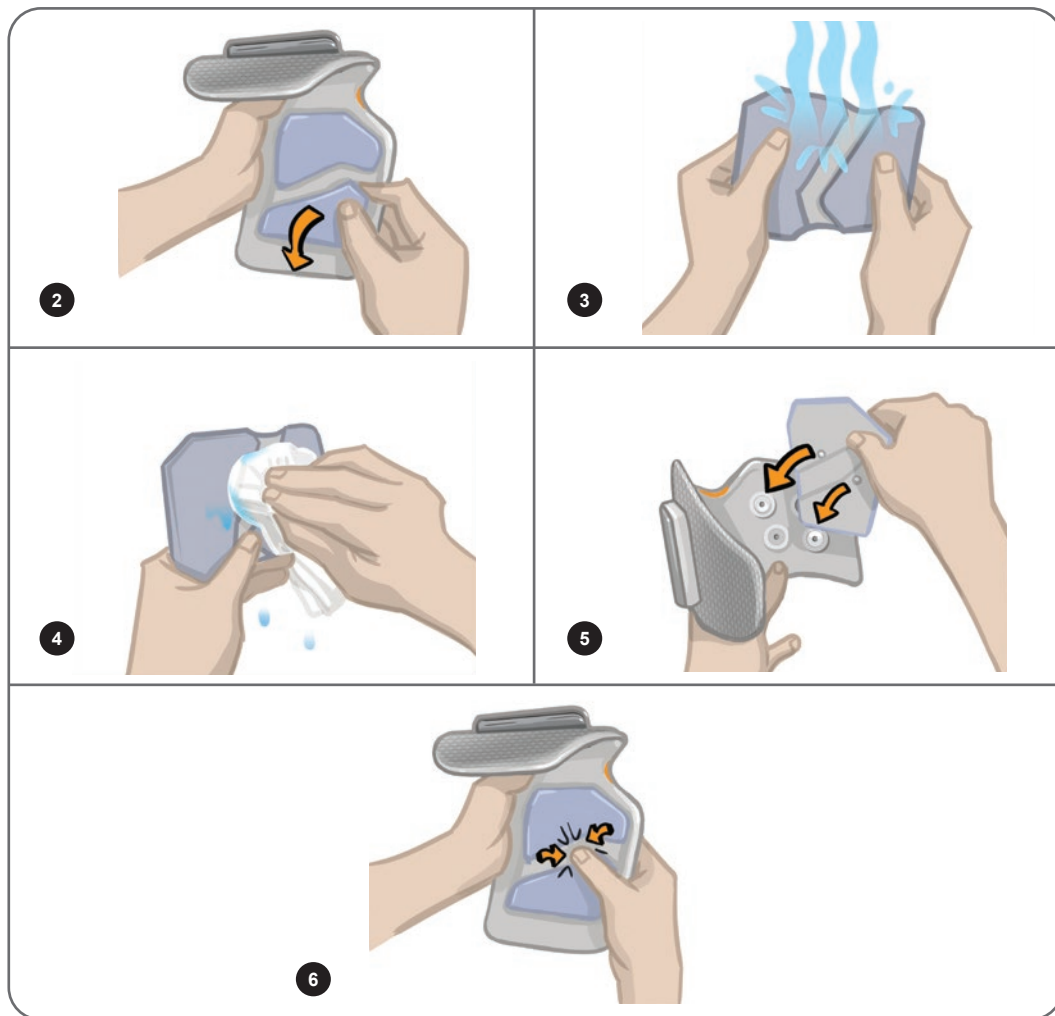
8-3. ábra: A gyors rögzítésű elektróda cseréje
