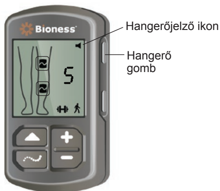
7-3. ábra: A vezérlőegységen található hangerő gomb
