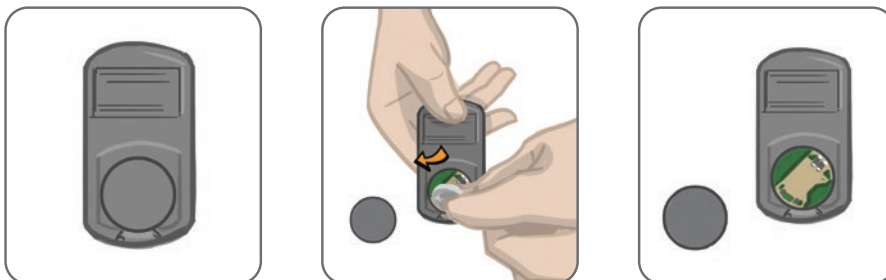
8-2. ábra: A vezérlőegység elemének cseréje
