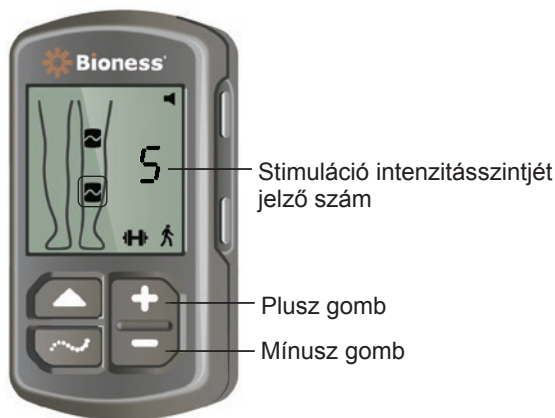
7-2. ábra: A stimuláció intenzitásának módosítása
