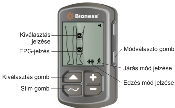
7-1. ábra: Az üzemmód kiválasztása a vezérlőegység segítségével
