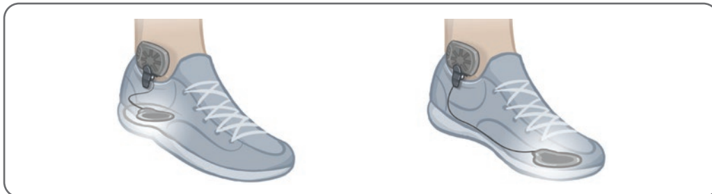
Figure 6-19 : Positionnement définitif du capteur talonnier fixé sur la chaussure
