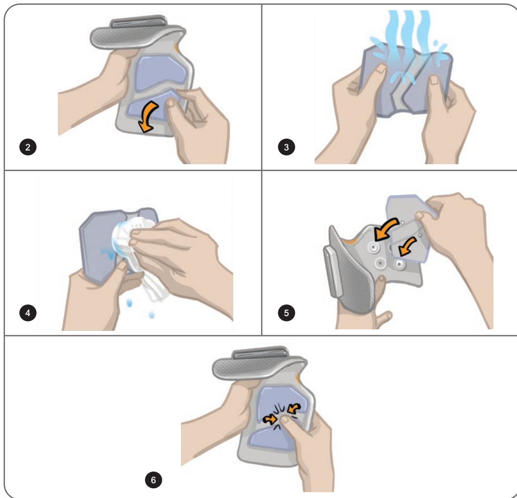
Figure 8-3 : Remplacement de l'électrode à installation rapide
