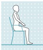
Przegub kolanowy przełącza opór na mniejszy, zarówno w kierunku zgięcia jak i w kierunku wyprostowania, jeśli pozycja siedząca jest zachowana, tzn. udo jest w pozycji przybliżonej do pozycji poziomej i kończyna dolna jest nieobciążona. Jeśli proteza nie była wystarczająco obciążona podczas siadania, siadanie odbywa się z wyprostowaną nogą. Poprzez pozycję podudzia zbliżoną do pozycji poziomej opór zgięcia zostaje automatycznie zredukowany i następuje samodzielne opadanie podudzia.
