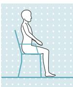
Hvis en sitteposisjon holdes, dvs. at låret er tilnærmet vannrett og beinet er ubelastet, kobler kneleddet til en lav motstand i både bøy- og strekkretningen.
