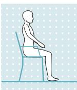
Hvis en sitteposisjon holdes, dvs. at låret er tilnærmet vannrett og beinet er ubelastet, kobler kneleddet til en lav motstand i både bøy- og strekkretningen.
