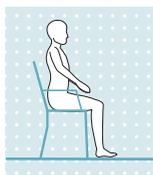
Przegub kolanowy przetęcza opór na mniejszy, zarówno w kierunku zgięcia jak i w kierunku wyprostowania, jeśli pozycja siedząca jest zachowana, tzn. udo jest w pozycji przybliżonej do pozycji poziomej i kończyna dolna jest nieobciążona. Jeśli proteza nie była wystarczająco obciążona podczas siadania, siadanie odbywa się z wyprostowaną nogą. Poprzez pozycję podudzia zbliżoną do pozycji poziomej opór zgięcia zostaje automatycznie zredukowany i następuje samodzielne opadanie podudzia.
