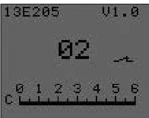
Omkopplingen mellan gripfunktion och rotation följer med hjälp av Dubbelkontraktion. Se kapitel 5.2. "Metoder för omkoppling". Dessutom kan en tillbakakoppling till gripfunktionen utföras också via en tidsstyrning. Återkopplingstiden ställs in med hjälp av MyoSelect 757T13. Den respektive inställningen kan avläsas genom skala C på MyoSelect's display.
