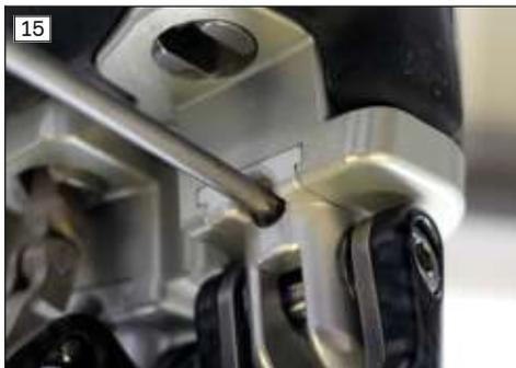
4) Apriete el tornillo de sujeción (varilla rosca-da) con  $50 \pm 5$  Ncm.
