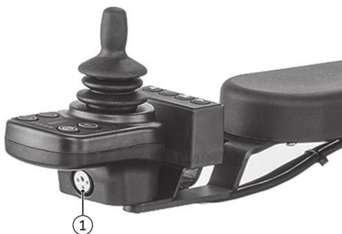
**Processo di carica tramite la console di comando**
