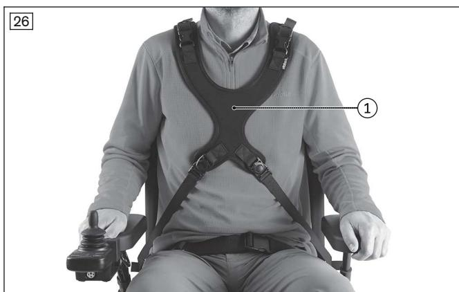
Električna invalidska kolica mogu biti opremljena pelotom za prsni koš i ramena.
