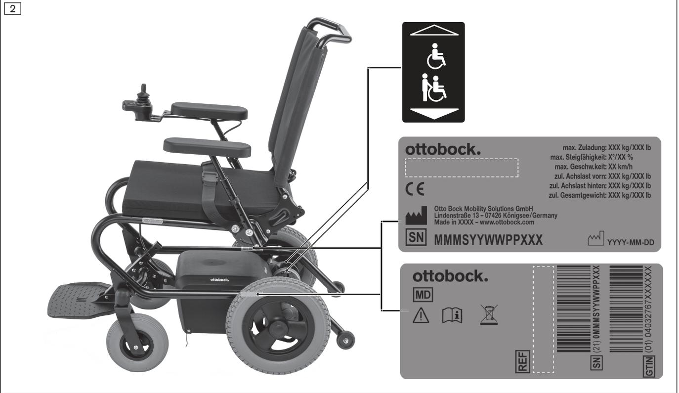
علامات التحذير ولوحات الاسم الموجودة بالكرسي المتحرك الكهربائي
