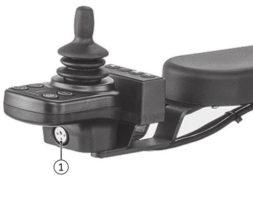
**Processo de carregamento através do painel de comando**
