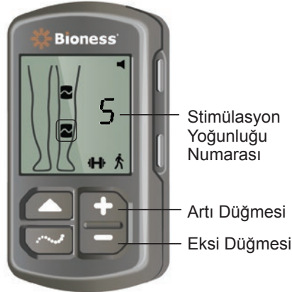
Şekil 7-2: Stimülasyon Yoğunluğunun Ayarlanması
