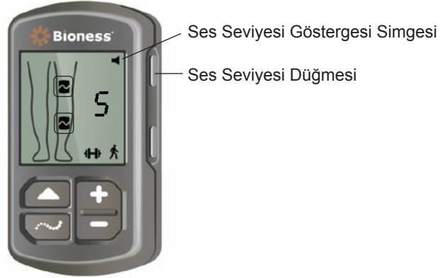
Şekil 7-3: Kumanda Birimindeki Ses Seviyesi Düğmesi
