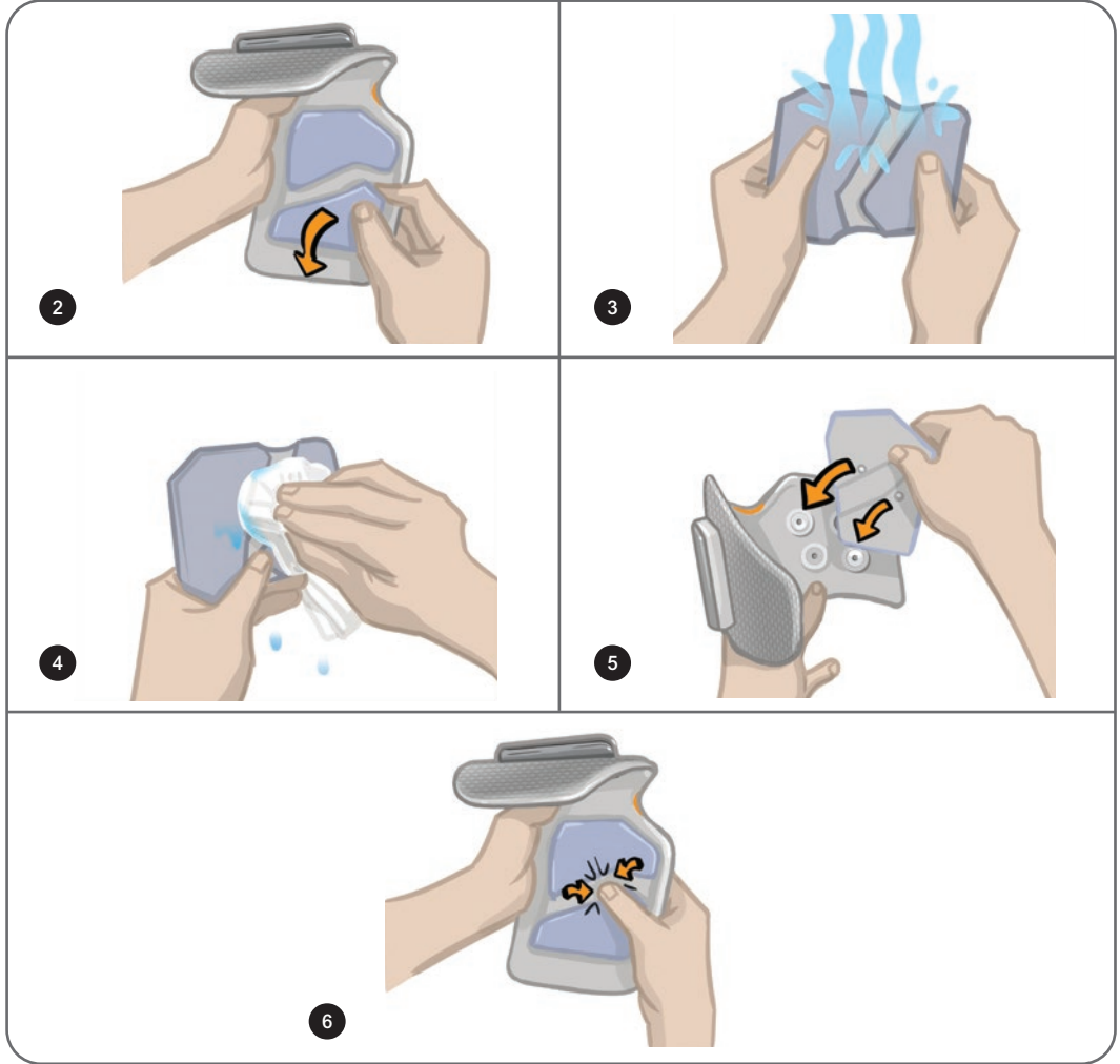
Şekil 8-3: Hızlı Takılan Elektrodu Değişirme
