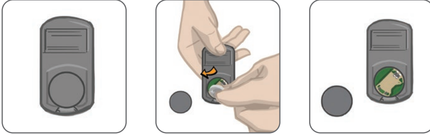
Şekil 8-2: Kumanda Birimi Pilini Değıştirme
