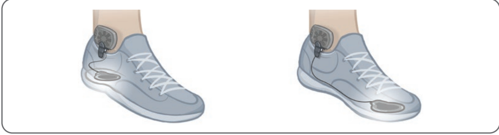
Şekil 6-19: Ayakkabıya Takılan Ayak Sensörünün Son Pozisyonu
