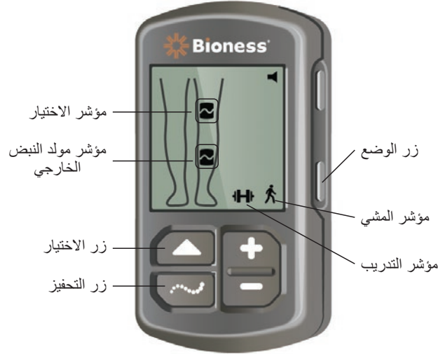
الشكل 4-8: اختيار وضع التشغيل في وحدة التحكم
