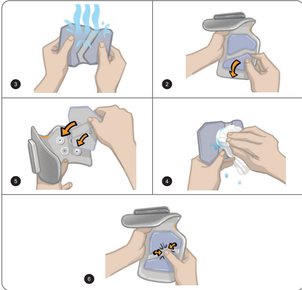
الشكل 3-11: استبدال الأقطاب الكهربائية سريعة التثبيت
