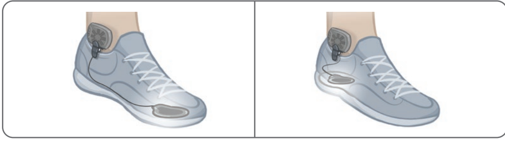
الشكل 8-14: الوضع النهائي لجهاز استشعار القدم الموصول بالحناء
