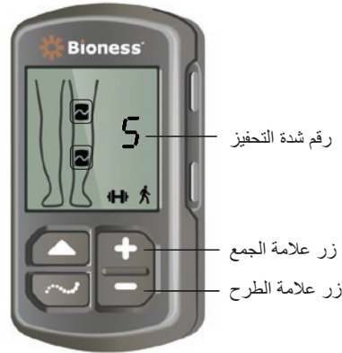
الشكل 9-4: ضبط شدة التحفيز
