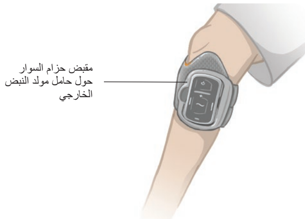
الشكل 1-6: سوار أسفل الساق العادي مثبت على الساق اليمنى بإحكام.
