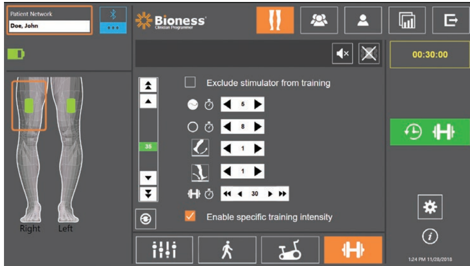
الشكل 9-9: برمجة التحفيز وشاشة إعدادات التدريب
