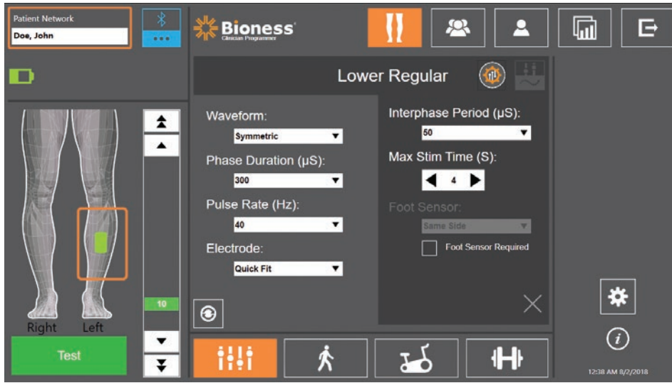
الشكل 9-4: برمجة التحفيز وشاشة المعلمة مع نافذة الإعدادات المتقدمة
