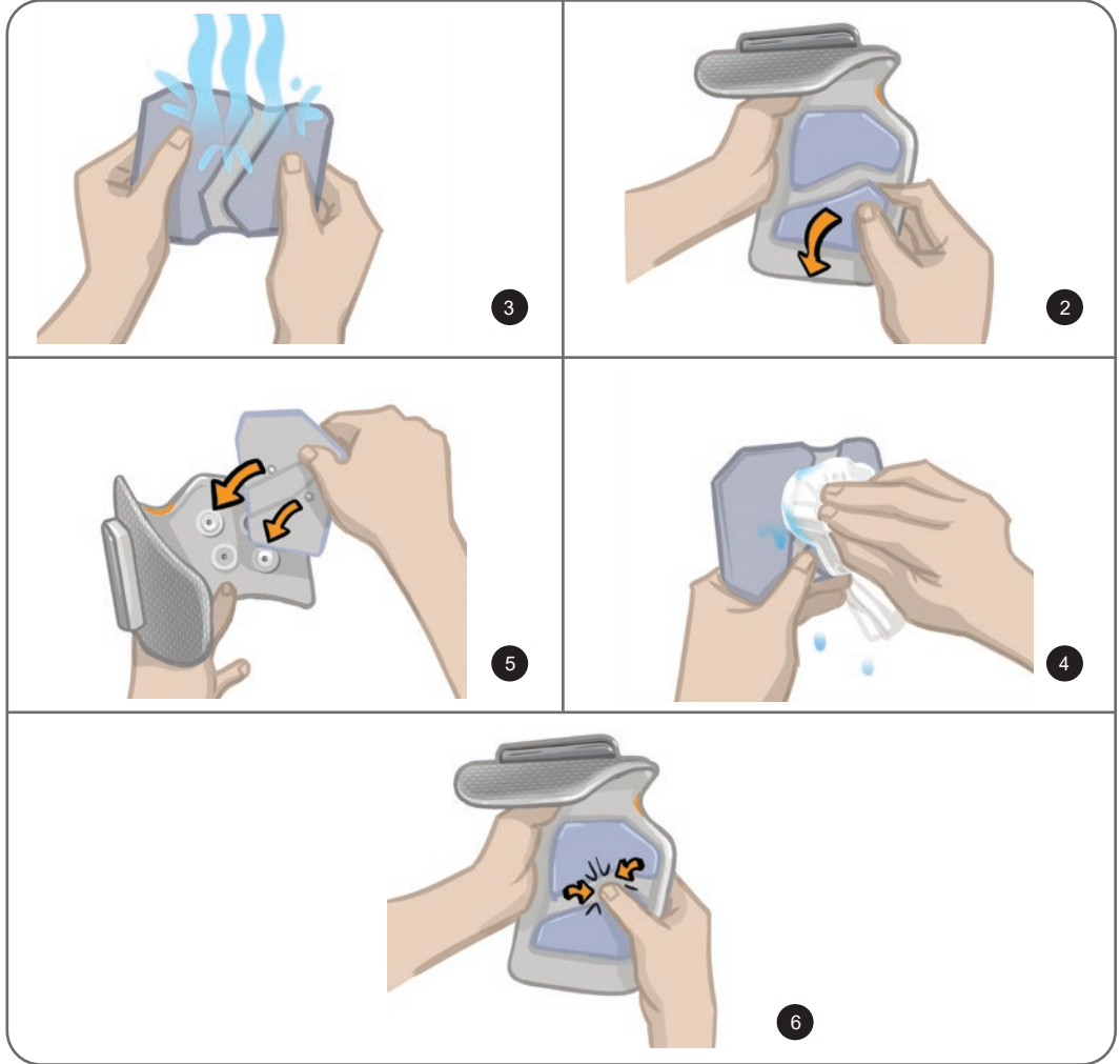
الشكل 3-8: استبدال الأقطاب الكهربائية سريعة التثبيت
