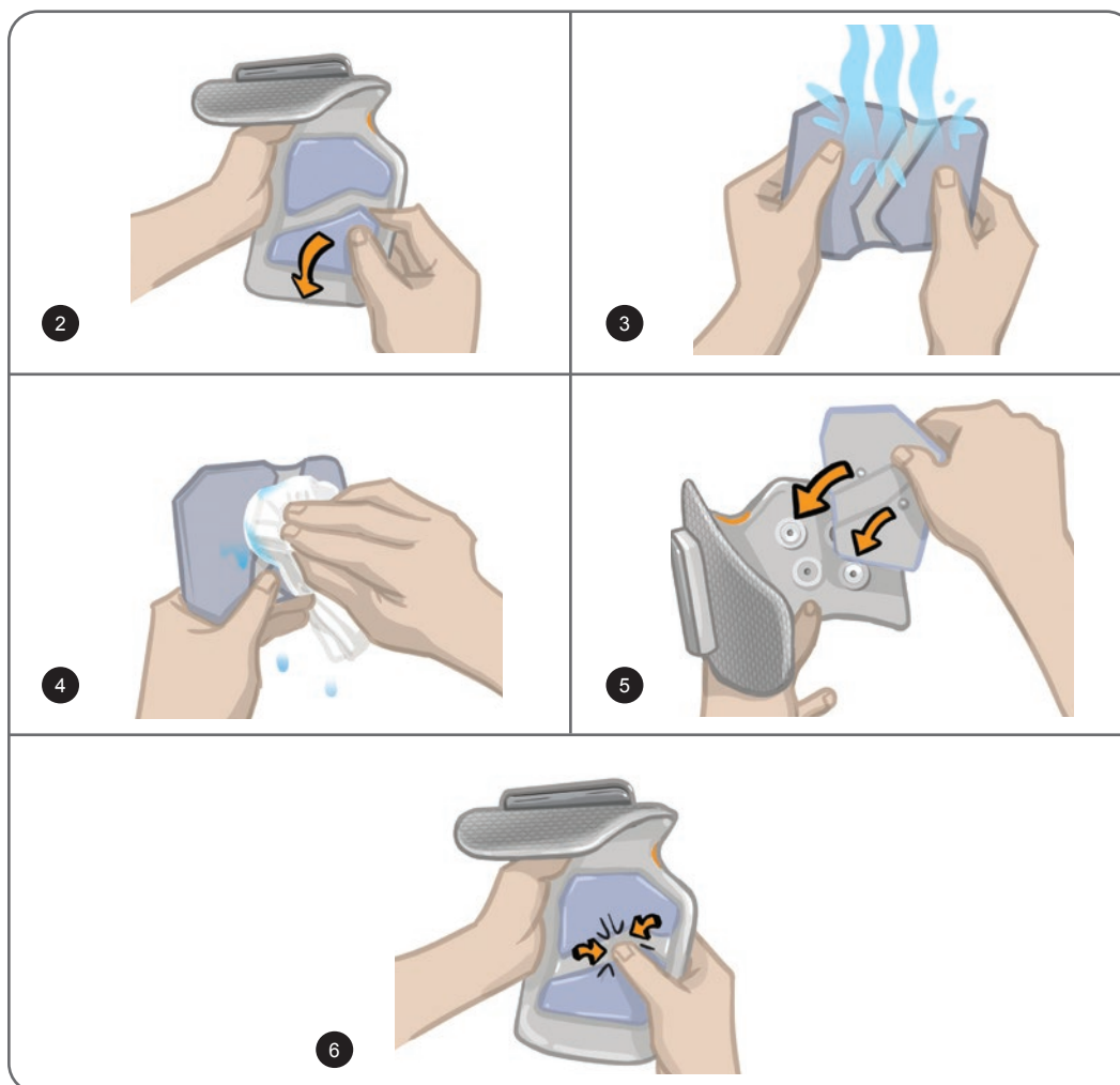
Figura 11-3: Înlocuirea electrodului cu fixare rapidă
