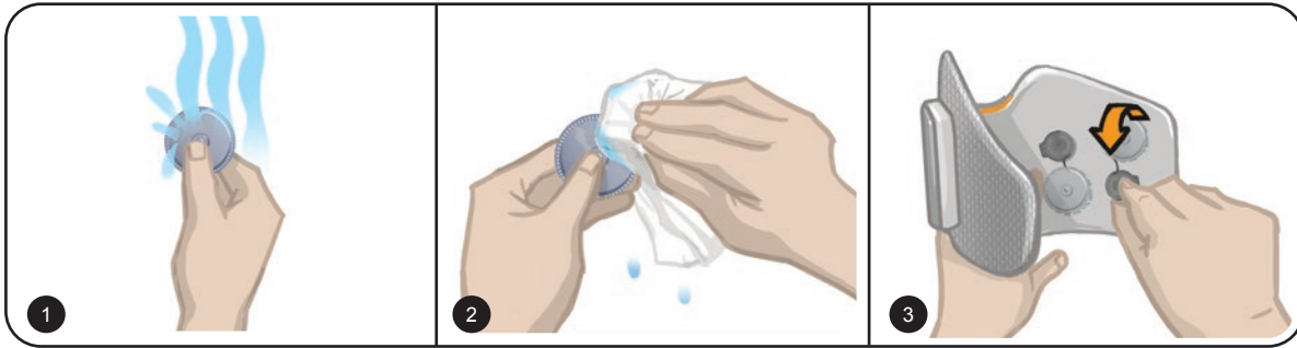
Figura 8-11: Potrivirea electrozilor pânzați rotunzi
