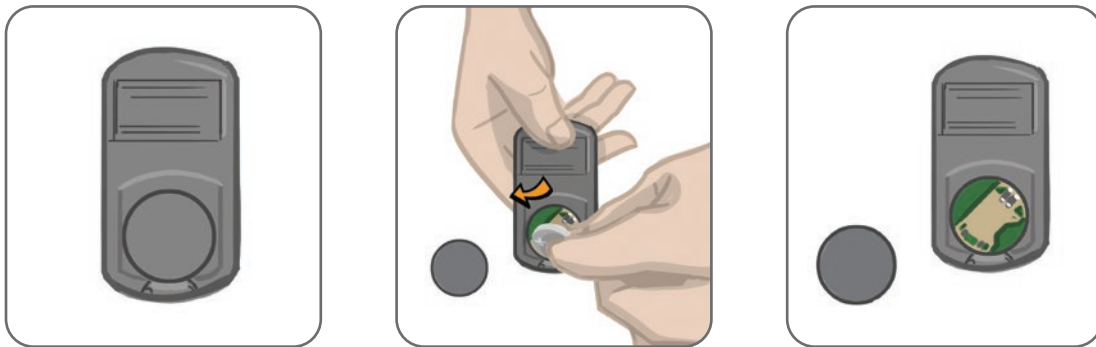
Figura 11-2: Înlocuirea bateriei unității de control
