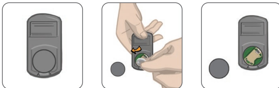
Afbeelding 8-2: De batterij van de bedieningseenheid vervangen
