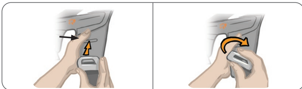
Afbeelding 8-13: De dijbanden vervangen
