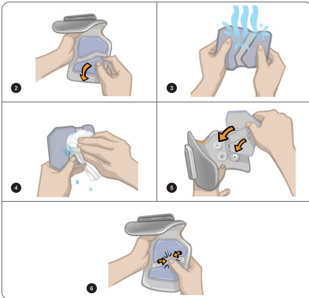
Afbeelding 11-3: De Quick Fit-elektrode vervangen
