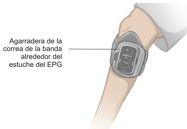
Ilustración 6-1: Banda de la parte inferior de la pierna normal abrochada en la pierna derecha.
