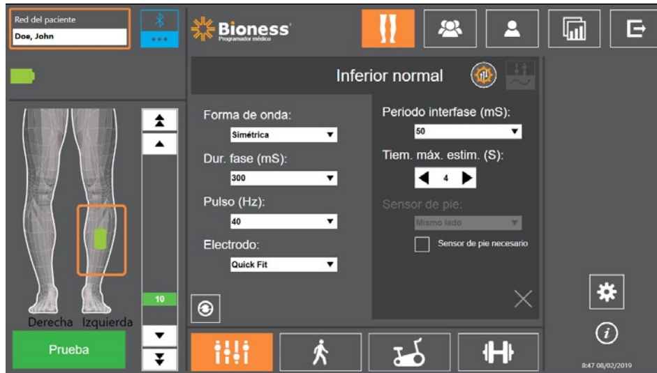
Ilustración 9-4: Programación de la estimulación: pantalla de parámetros con la ventana de configuración avanzada
