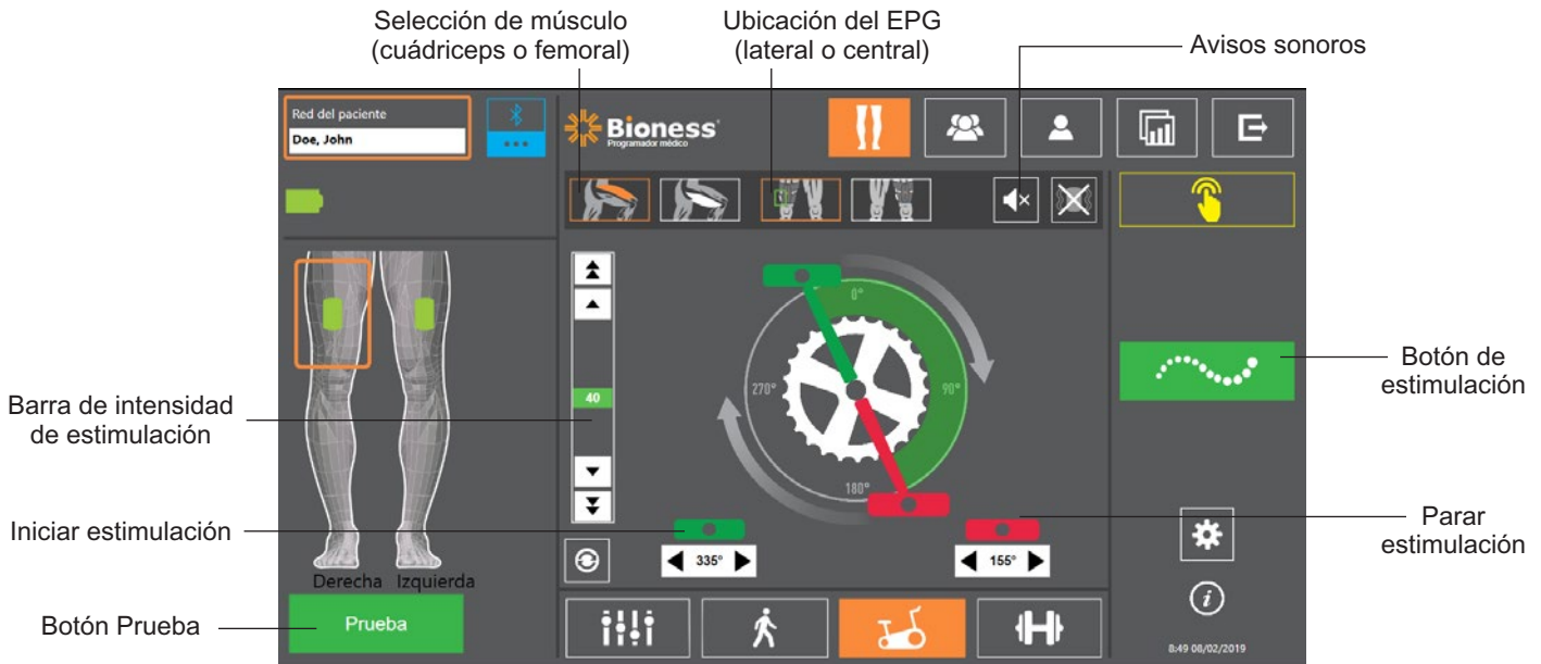
Ilustración 9-8: Programación de la estimulación: pantalla de configuración del entrenamiento de bici
