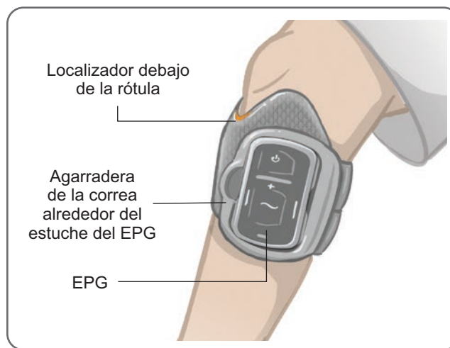
Ilustración 8-8: Banda de la parte inferior de la pierna en la pierna derecha
