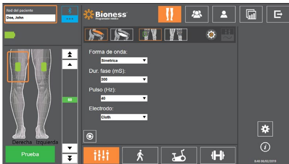
Ilustración 9-7: Programación de la estimulación: pantalla de configuración de parámetros
