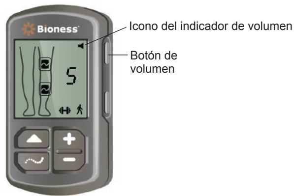
Ilustración 4-10: Botón de volumen en la unidad de control
