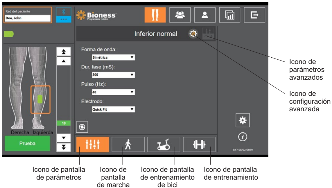
Ilustración 7-5: Pantalla de configuración de la programación (con la pantalla de submenú de estimulación mostrada)
