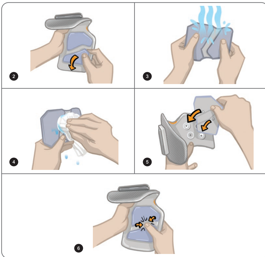
Ilustración 11-3: Sustitución del Electrodo Quick Fit
