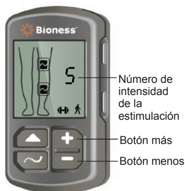
Ilustración 4-9: Ajuste de la intensidad de la estimulación
