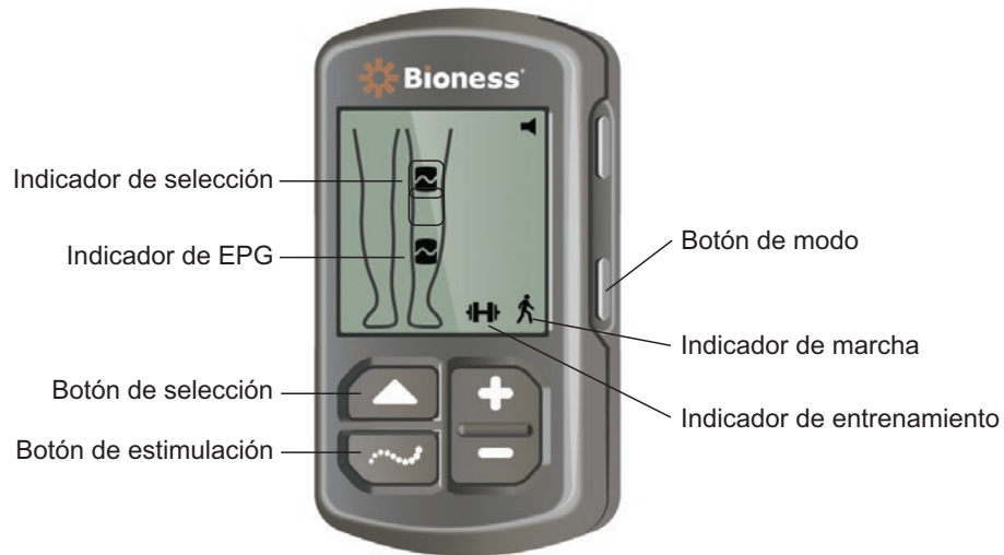
Ilustración 4-8: Selección de un modo de funcionamiento en la unidad de control
