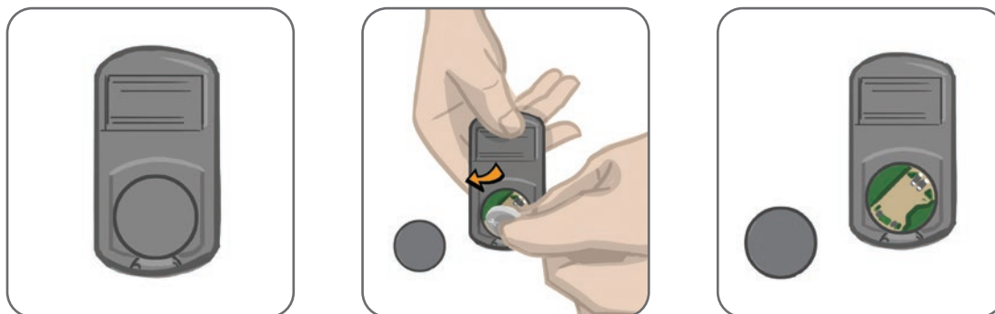
Obrázek 11-2: Výměna baterie řídicí jednotky
