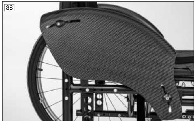
**Pieza lateral "de plástico, desmontable"** (véase fig. 39)
