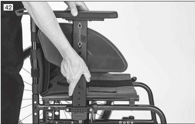
**Desmontar/fijar las piezas laterales con acolchado del reposabrazos corto y las piezas laterales con acolchado del reposabrazos largo, de profundidad regulable**
