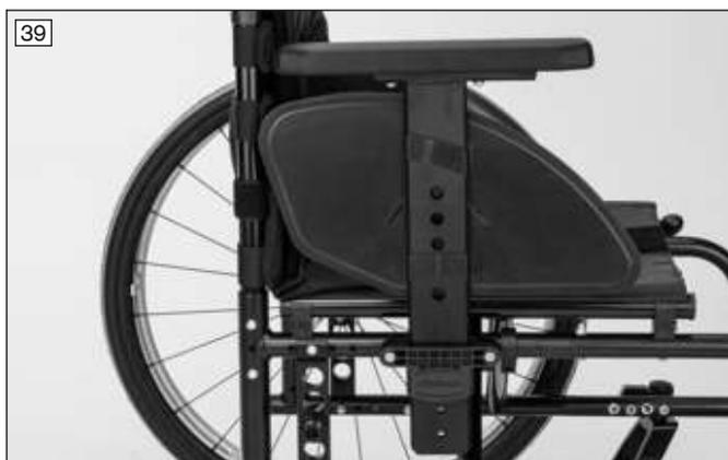
**Pieza lateral con acolchado del reposabrazos corto; pieza lateral con acolchado del reposabrazos largo, de profundidad regulable** (véase fig. 40)
