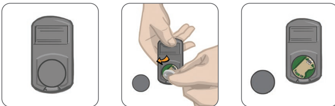
Obrázok 11-2: Výmena batérie v riadiacej jednotke
