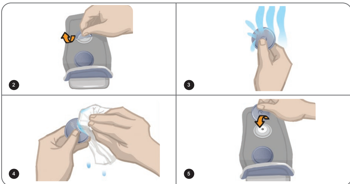
Obrázok 8-9: Upevnenie malých okrúhlych látkových elektród
