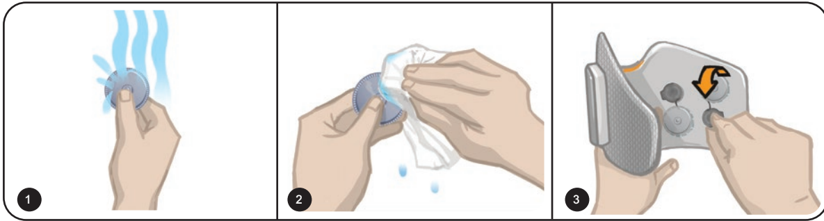
Obrázok 8-11: Upevnenie okrúhlej látkovej elektródy
