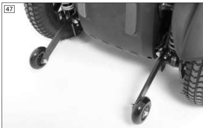
Der Kippschutz macht das Fahren sicherer (siehe Abb. 47). Er verhindert bei einem Heckantrieb das Abkippen des Rollstuhls nach hinten.
