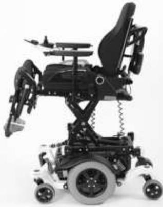
Durch die elektrische Sitzhöhenverstellung wird die Sitzfläche über einen Motorantrieb um **350 mm (13,8")** angehoben.
