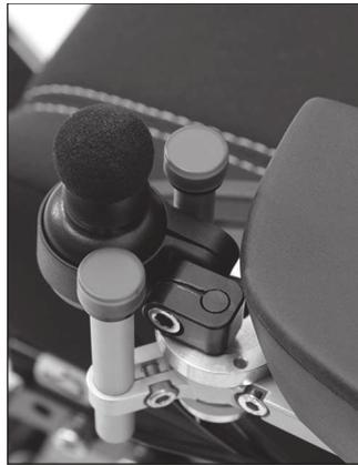
Der Joystick wurde an der Armauflage montiert (siehe Abb. 99, links). Dadurch kann der Benutzer den Joystick gut erreichen.
