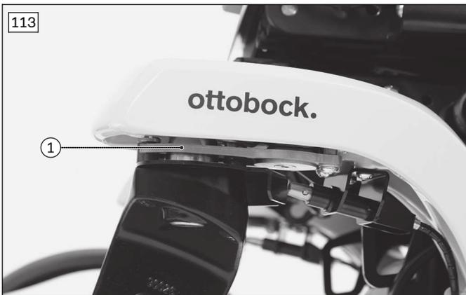
Die mechanische Spurstabilisierung (siehe Abb. 113, Pos. 1) stabilisiert unterhalb der Lenkradschwinge die Lenkräder in der schnellen Vorwärtsbewegung. Dadurch wird bei Geradeausfahrten (z. B. im Straßenverkehr) die Spur besser gehalten.
