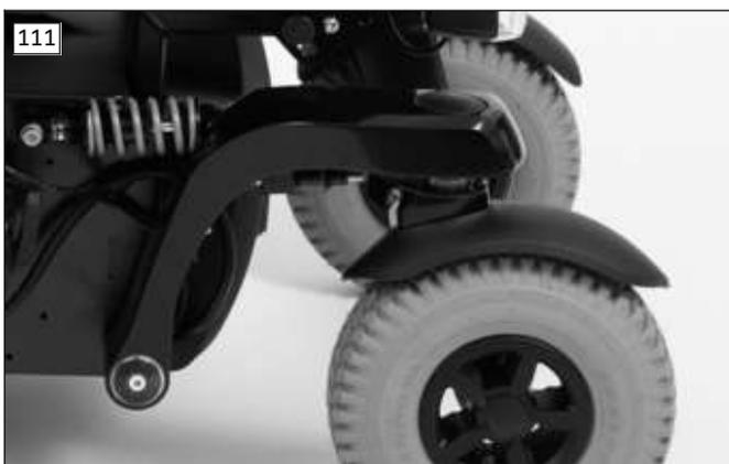
Gli Spring element sui due bracci oscillanti delle ruote direzionali migliorano il comfort di guida in particolare su terreni irregolari.
