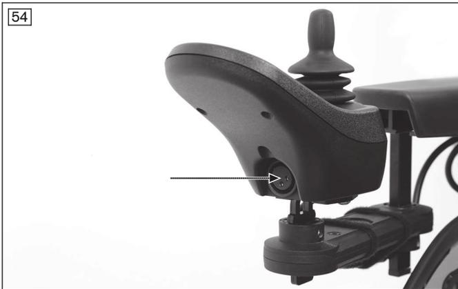
**Processo di carica tramite la console di comando**
