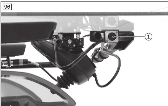
**Processo di carica mediante la presa di carica esterna**
