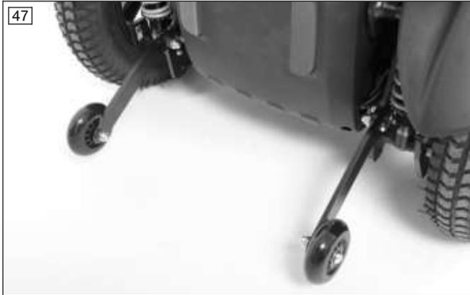
La ruotina antiribaltamento rende più sicura la marcia (v. fig. 47). In caso di trazione posteriore impedisce che la carrozzina si ribalti all'indietro.
