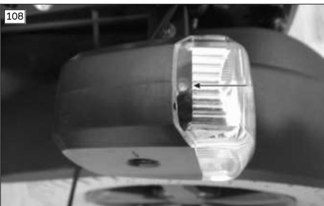
Con l'unità di comando attivata il sensore crepuscolare integrato (v. fig. 108, freccia) provvede all'accensione o allo spegnimento automatico delle luci a seconda della luminosità dell'ambiente.
