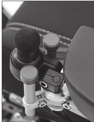
Il joystick è stato montato sul bracciolo (v. fig. 99, a sinistra). L'utente può così raggiungere bene il joystick.
