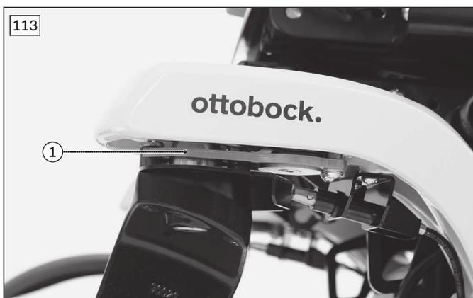
L'elemento meccanico di mantenimento della corsia posto sotto il braccio oscillante (v. fig. 113, pos. 1) stabilizza le ruote direzionali nel movimento veloce in avanti.
