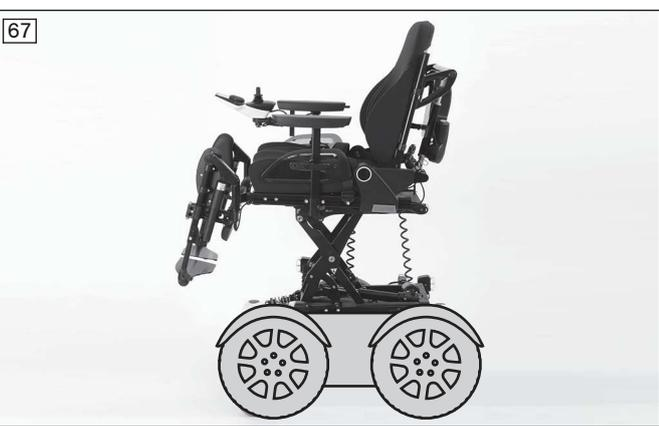
La funzione di regolazione elettrica in altezza del sedile consente di sollevare di **350 mm (13,8")** la seduta mediante comando a motore.
