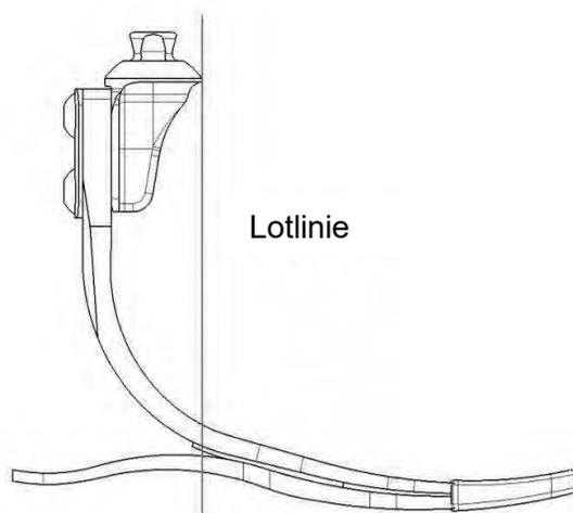
**Dynamischer Aufbau** Während der *Lastübernahme* nimmt die Rückfußfeder Energie auf und kann diese beim Übergang zur *mittleren Standphase* wieder abgeben. Die in der mittleren Standphase bis zum Zehenabstoß durch die Fußfeder aufgenommene Energie wird beim Zehenabstoß wieder abgegeben. Die Abrollbewegung von Fersenauftritt zur Zehenabstoß wird anhand folgender Variablen eingestellt:
