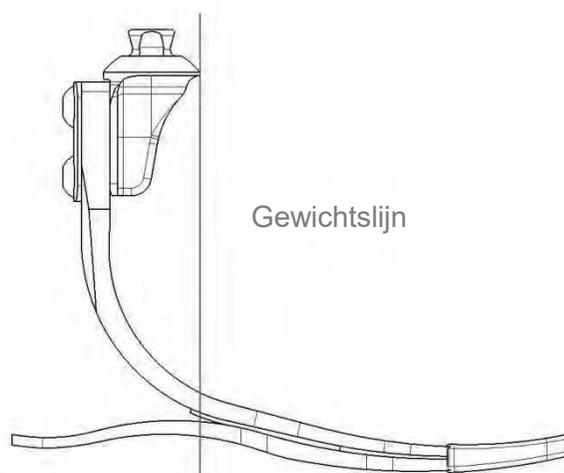
**Dynamische uitlijning** Tijdens het *neerzetten van de voet* slaat de hiel energie op en tijdens de *middenstandsfase* wordt deze vrijgegeven. Deze actie biedt momentum voor de kiel om energie op te slaan en deze vrij te geven tijdens de *laatste fase van het afwikkelen*. Om de afwikkeling van hak naar teen te optimaliseren, kunnen de volgende variabelen worden aangepast:
