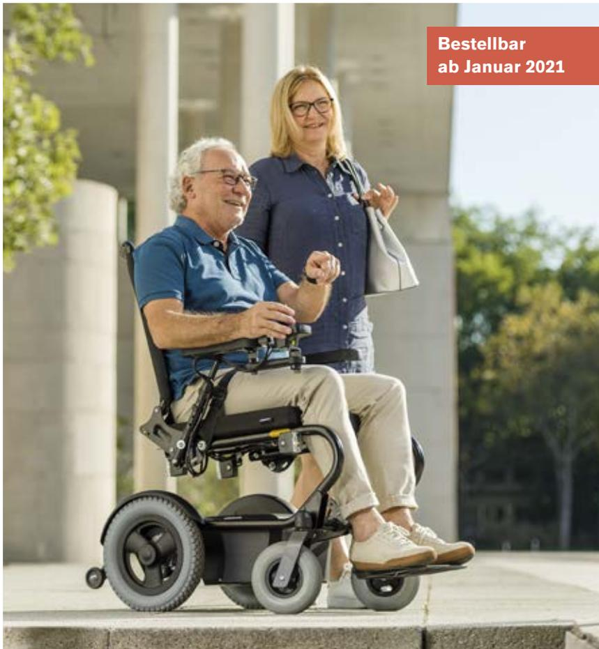
Der Wingus ist ein heckantriebener Sit'n'Drive Elektrorollstuhl, welcher gleichermaßen für den Innen- und Außenbereich geeignet ist. Dieses kompakte und wendige Einstiegsmodell verfügt über eine innovative selbstfedernde Rahmenkonstruktion, welche für hohen Fahrkomfort sorgt. Er kombiniert langzeitgeprüfte Funktionalität mit einem ansprechenden und minimalistischen Design: Verlässlichkeit made in Germany.
