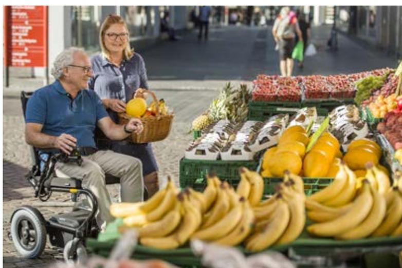
Der Wingus ist ein echter Hingucker. Als heckantriebener Elektrorollstuhl für den Innen- und Außenbereich entwickelt besticht er durch sein reduziertes Design. Sein innovativer selbstfedernder Rahmen sorgt für hohen Komfort beim Fahren auf unwegsamem Terrain.
