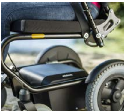
• Hoher Sitzkomfort durch freischwingende Rahmenkonstruktion
