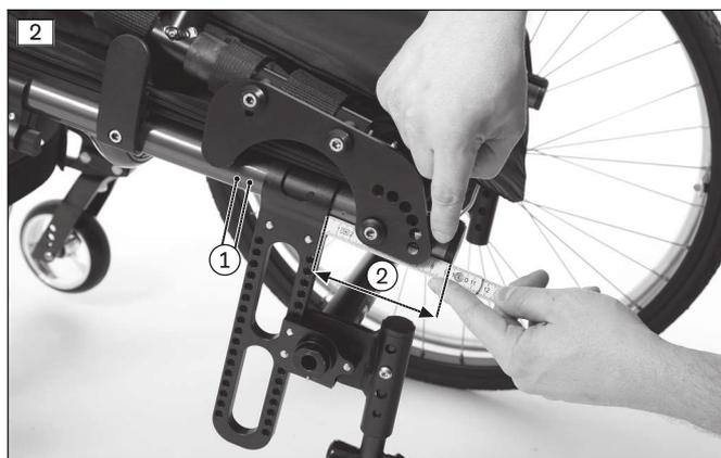
**6.2.1.2 Desplazamiento de los pasadores con sistema de amortiguación de choques**
