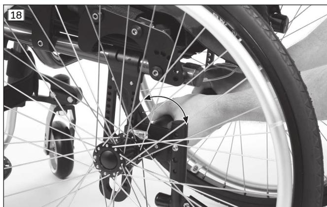
**6.2.6 Ajustar el eje desmontable**
