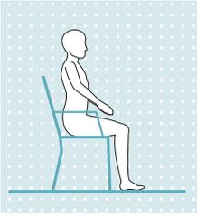
Se si trova in posizione seduta per più di due secondi, vale a dire se la coscia è pressoché orizzontale e la gamba non sottoposta a carico, il prodotto regola la resistenza in direzione di estensione a un valore minimo.
