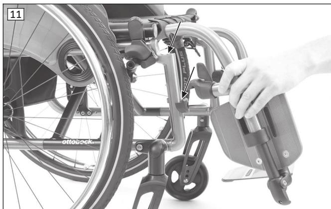
**Abnehmen der Beinstützen – Beinstütze hochschwenkbar**
