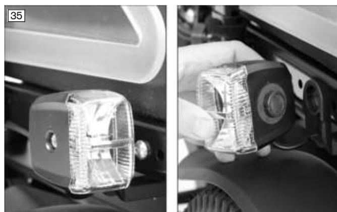
Die Frontbeleuchtung besteht aus 2 Frontleuchten mit integrierten Blinkern (siehe Abb. 35, links).
