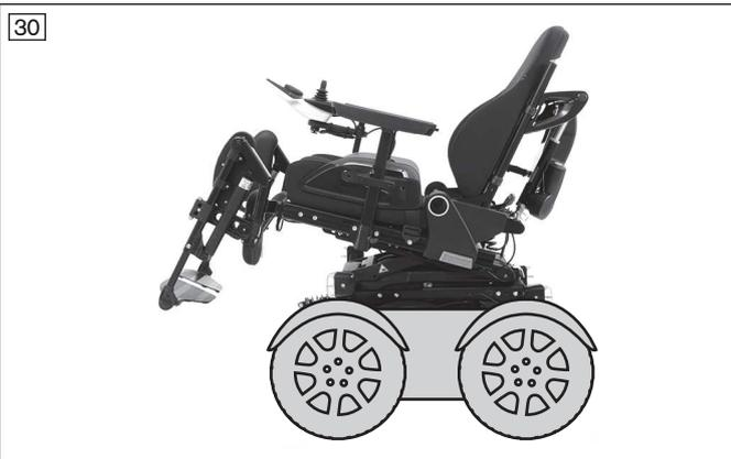
Die elektrische Sitzkantung ermöglicht ein Neigen des Sitzes, z. B. zur Druckentlastung bis **45°** (mit Schwerpunktverlagerung).
