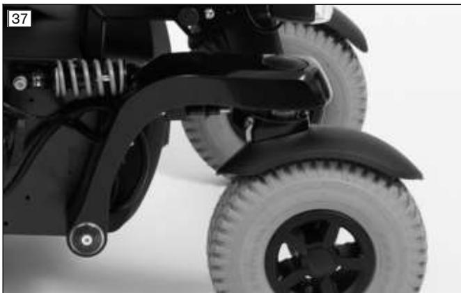
Die Federelemente an den Lenkradschwingen erhöhen den Fahrkomfort insbesondere beim Befahren unebener Strecken.
