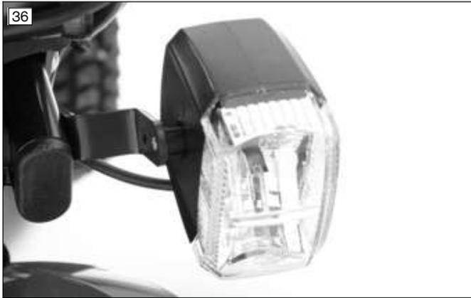
Die Heckbeleuchtung besteht aus 2 LED-Heckleuchten mit integrierten Blinkern.
