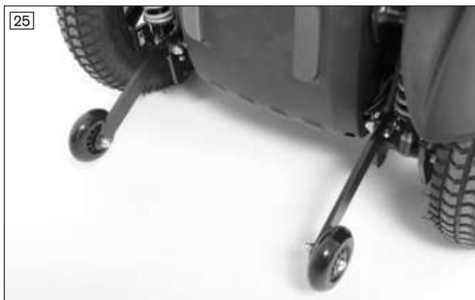
Der Kippschutz macht das Fahren sicherer (siehe Abb. 25). Er verhindert bei einem Heckantrieb das Abkippen des Rollstuhls nach hinten.
