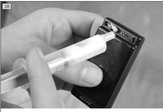
**INFORMACIÓN:** el uso de grasa de silicona **633F11** protege los contactos y las conexiones de los cables contra la oxidación.
