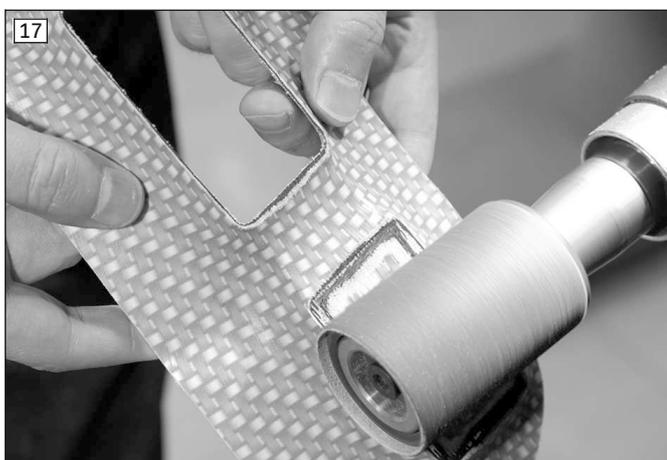
Desmolde la carcasa de revestimiento una vez seca. Lije con cuidado en plano las plantillas de laminado de la batería con soporte y del sistema electrónico con soporte hasta los bordes.
