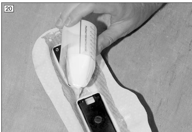
Gire la carcasa de revestimiento de tal modo que los soportes puedan verse desde el interior. Mezcle una pequeña cantidad de resina de sellar con una cantidad suficiente de endurecedor. No utilice demasiado endurecedor puesto que, de lo contrario, la resina formará burbujas al endurecerse, y la unión se volverá quebradiza. Pegue el soporte con la carcasa de revestimiento. Aplique con cuidado un pequeño chorro de resina de sellar en la hendidura alrededor del soporte.
