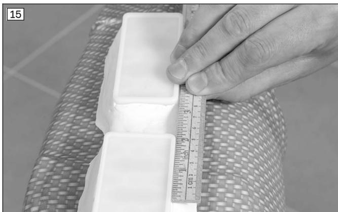
Fije las plantillas de laminado para los componentes del sistema electrónico sobre el modelo con una tira de cinta adhesiva doble. Rellene con plastilina los bordes entre las plantillas y el encaje para lograr una transición homogénea.
