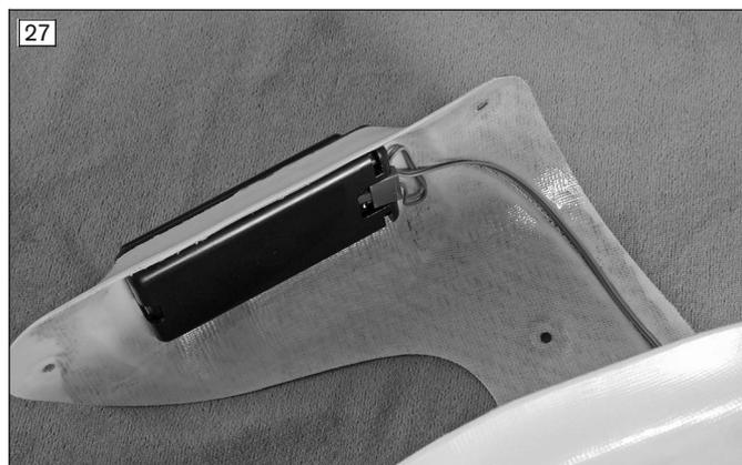
Tienda el cable desde el sistema electrónico hasta la batería. Fije el cable con cinta adhesiva de doble cara en el canal para cables de la carcasa de revestimiento.
