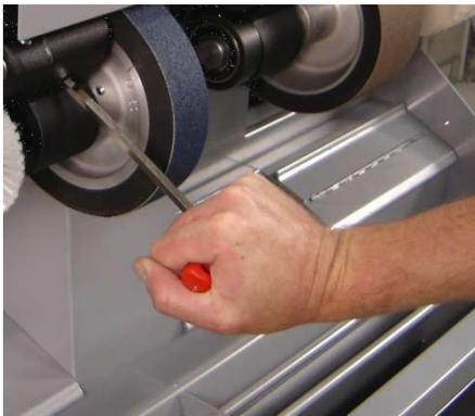
Veillez à ce que les courroies ne tournent pas. Utilisez la barre de déverrouillage. La barre de déverrouillage est placée comme indiqué sur la figure 5. Insérez cette barre dans le mécanisme de verrouillage et déplacez-la vers le bas jusqu'à la butée. Une fois que la courroie abrasive n'est plus sous tension, vous pouvez la retirer.
