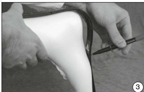
Représenter le RC sous le pied. La longueur s'étend du calcanéum jusqu'à env. 20 mm avant la zone de déroulement. Pour finir, déterminer la longueur du mollet du RC. L'extrémité du RC s'étend jusqu'à 20 mm sous la zone de flexion.
