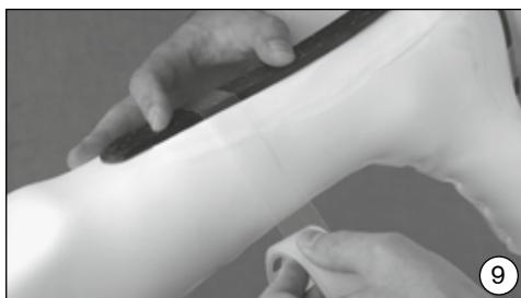
Molde preparado para embutir en profundidad. Fijar el resorte de carbono por encima del empeine y por debajo del peroné con cinta adhesiva de polietileno (627B4) sobre el molde. Embutar 1 manga de malla de perlón por encima del molde.
