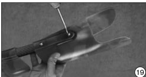
CF skrues fast med den medleverede Niro linsesænkeskruer 501S86 og de medleverede rosettespændeskiver 507U9. Rosettespænskiven forhindrer, at skruerne presser sig ind i polypropylenen, og ødelægger kontaktfladen.
