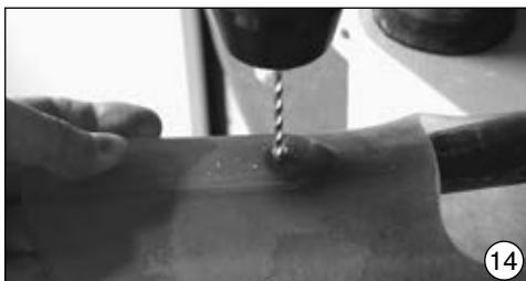
Utiliser une perceuse de 4 mm pour M4 pour percer le trou dans le polypropylène. Utiliser une perceuse de 5 mm pour le M5.
