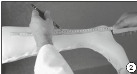
Diviser le modèle en deux parties pour déterminer la zone de fixation et de mouvement du ressort en carbone (RC). Mesurer la distance de l'interligne articulaire du genou au sol et indiquer le milieu (voir schéma 3).
