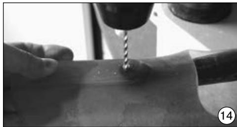
M4用には4mmのドリルを使用し、ポリプロピレンに穴をあけます。M5用には5mmドリルを使用します。
