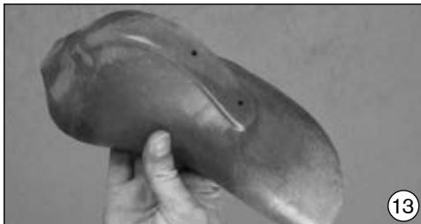
Vyznačení míst pro vyvrtání otvorů na chodidlové části. Proximální otvor neumísťujte na nejvyšším místě paty, poněvadž zde již probíhá oblast ohybu karbonové pružiny.
