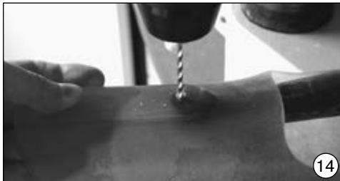
Para el orificio en el propileno, usar una broca de 4 mm para M4. En caso de M5 usar una broca de 5 mm.
