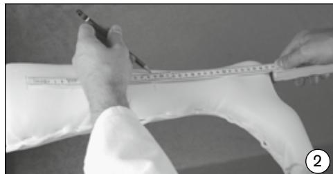
Celem ustalenia strefy mocowania i ruchu dla szyny sprężystej „Carbonfeder” (CF) należy podzielić model na dwie części. Zmierzyć wymiar od kolana do spodu stopy i zaznaczyć na połówkach (patrz szkic 3).
