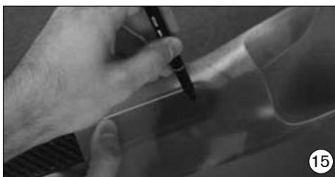
Přidržte CF zespodu a vyznačte díry pro vyvrtání.
