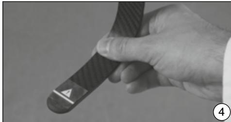
CF må maksimalt forkortes til markeringen, da en sikker fiksering på foddelen ellers ikke er mulig. Afrund skærekanter.
