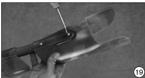
CF mit den beigefügten Niro Linsensenkschrauben 501S86 und der beigefügten Rosettenscheiben 507U9 verschrauben. Die Rosettenscheiben verhindern ein Einpressen der Schrauben in das Polypropylen und vergrößern die Auflagefläche.
