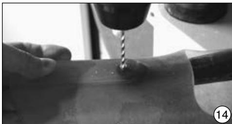
K vyvrtání díry v polypropylénu pro šroub M4 použijte vrták o průměru 4 mm. U šroubu M5 použijte vrták o průměru 5 mm.
