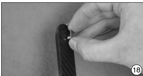
Inserire il dado per saldatura.
