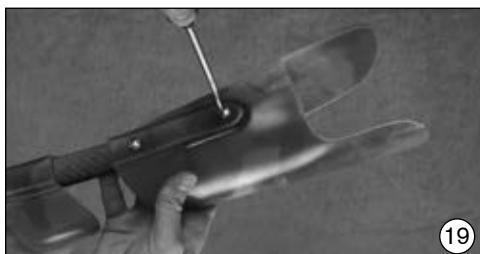
Aparafusar CF com os parafusos com cabeça lenticular Niro 501S86 e as anilhas 507U9. As anilhas evitam que os parafusos forcem o polipropileno e aumentam a área de contacto.
