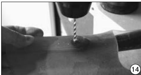
Na otvor v polypropyléne použite 4 mm vrták pre M4. V prípade M5 použite 5 mm vrták.
