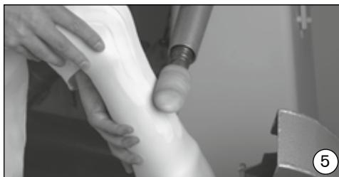
Per adattare la molla in fibra di carbonio alla tibia, occorre strutturare e frescare l'inlett in determinati punti. Può rendersi necessario pareggiare alcuni punti cavi.
