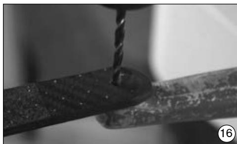
カラーナット(502E3)用に、5mmの穴を開けます(M4用)。M5の場合は6.5mmの穴を開けます。
