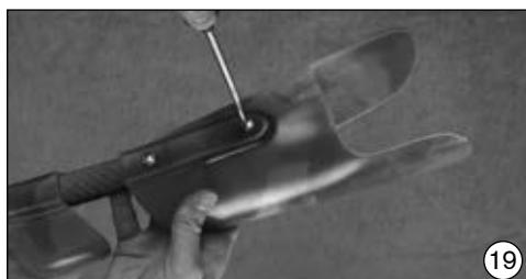
付属の皿頭ネジ(501S86)とロゼッタワッシャー(507U9)を用いてカーポンスプリングをネジ留めします。ロゼッタワッシャーは、ネジがポリプロピレンに押し込まれるのを防ぎ、広い接触面を確保します。
