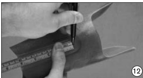
Vyznačení míst pro vyvrtání otvorů na lýtkové části. Pomocí pravítka můžete narýsovat střed.
