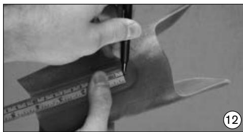
下腿カフ部品の上にネジ穴の印をつけます。定規を用いて中央に印をつけることもできます。
