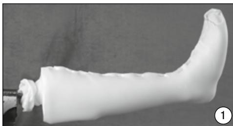
Recouvrir le positif plâtré d'une couche de tricot en perlon et réaliser une enveloppe en Pedilin (617S3=W5).
