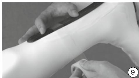
真空成形のための準備：ポリエチレン粘着テープ(627B4)を用いて、カーボンスプリングを固定します。その後、モデルにペルロンストッキネットを1枚被せます。
