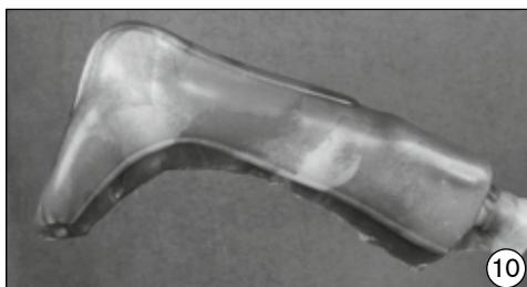
Para o repuxamento profundo utilizar polipropileno 616T20=2000×4 para todos os tamanhos 4 mm. O material sintético tem de ser moldado ao molde sob vácuo.
