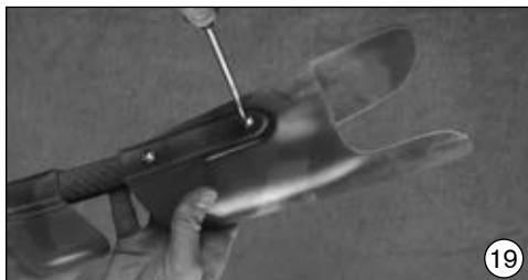
Пружину из карбонового волокна привинтить с помощью входящих в комплект поставки винтов с полупотайной головкой Niro 501S86 и шайбы-розетки 507U9. Шайбы-розетки предотвращают продавливание винтов в полипропилен и увеличивают поверхность их прилегания.
