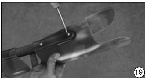
Skru på KF med de vedlagte Niro linsesenkeskruene 501S86 og de vedlagte rosettskivene 507U9. Rosettskivene hindrer at skruene presses inn i polypropylenet og forstørrer bæreflaten.
