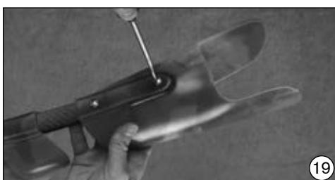
Přišroubujte CF pomocí přiložených nerez ocelových šroubů s čočkovou hlavou 501S86 a přiložených hvězdicových podložek 507U9. Hvězdicové podložky zabraňují vmáčknutí šroubů do polypropylénu a zvětšují dosedací plochu.
