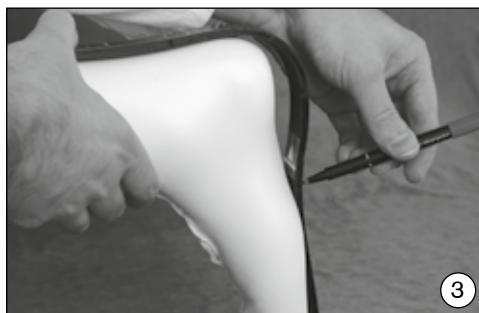
Markering av legglengden. Enden til KF rekker til 20 mm under bøyningsutsnittet.
