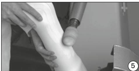
Para adaptar a CF à parte inferior da coxa, a palmilha tem de ser montada nos locais correspondentes e rectificada de modo a se adaptar perfeitamente. Eventualmente poderá ser necessário nivelar áreas ocaas.
