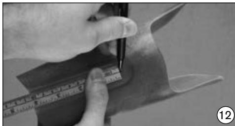
Επισημάνετε τις οπές στο τμήμα της κνήμης. Επισημάνετε το μέσο χρησιμοποιώντας ένα χάρακα.
