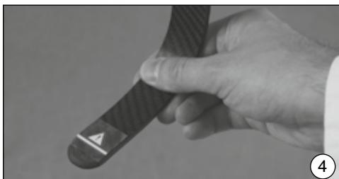
Szyna CF może być skracana maksymalnie do oznaczonego miejsca, gdyż zbyt krótko ucięta nie pozwala na wytworzenie stabilnego usztywnienia w części obejmującej stopę. Wszystkie krawędzie po cięciu należy zaokrąglić.
