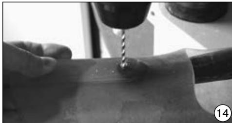
Για την οπή στο πολυπροπυλένιο χρησιμοποιήστε τρυπάνι 4 mm για M4. Για M5, χρησιμοποιήστε τρυπάνι 5 mm.
