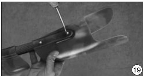
CF birlikte teslim edilmiş olan Niro mercimek gömme başlı vida 501S86 ve birlikte teslim edilmiş olan rozet pulu 507U9 ile vidalanmalıdır. Rozet pulları vidaların polipropilene sıkışmasını önerir ve bağlantı yüzeyini büyütür.
