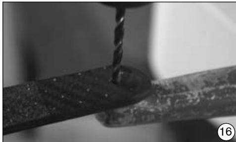
Percer un trou de 5 mm pour l'écrou à souder 502E3 (pour le M4). Réaliser un trou de 6,5 mm pour le M5.
