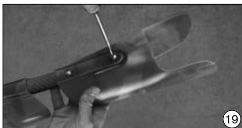
Visser le RC à l'aide des vis à tête goutte de suif Niro 501S86 et des rondelles 507U9 fournies. Ces dernières empêchent les vis d'être enfoncées dans le polypropylène et agrandissent la surface d'appui.
