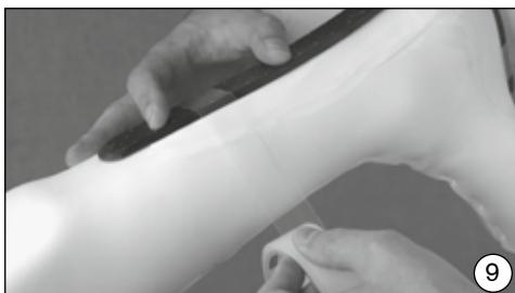
Förbered modellen för djupa sträckningar. Fixera KF över vristen och under vadnen med polyetetape (627B4) på modellen. Dra över en perlontrikåslang över modellen.
