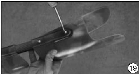
Avvitare la molla in fibra di carbonio con le viti a testa svasata Niro (501S86) e le rondelle 507U9 in dotazione. Le rondelle impediscono che le viti penetrino nel polipropilene e aumentano la superficie d'appoggio.
