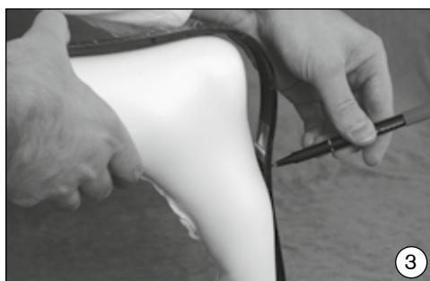
足部の底面にカーボンスプリングを添わせます。踵骨から見て、カーボンスプリングの長さは踏み返し部分から最大約20mm手前でカットします。次に、装具の下腿部の長さを決めます。下腿部は、装具後壁トリミングラインから約20mm下の位置でカットします。
