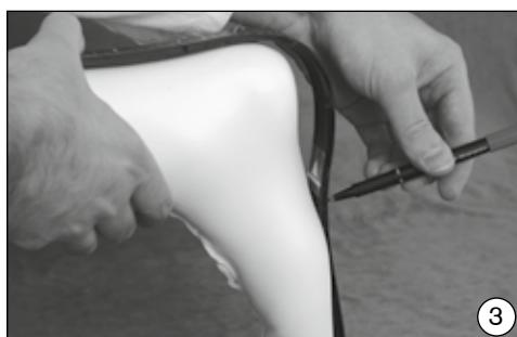
Baldır uzunluğunun işaretlenmesi. CF'nin ucu, bükme kesitinin 20 mm altına kadar yeterlidir.
