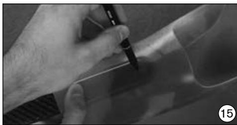
Leg de CV onder het polypropyleen en teken de boorgaten op de CV af.
