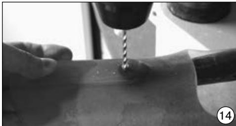
Für das Loch im Polypropylen einem 4 mm Bohrer für M4 verwenden. Bei M5 einen 5 mm Bohrer verwenden.
