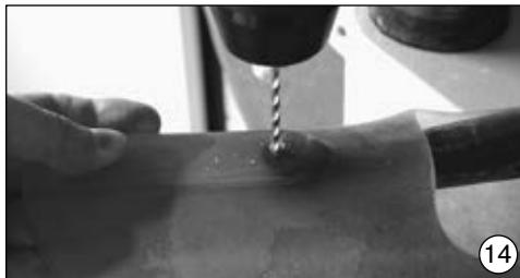
Gebruik voor het gat in het polypropyleen voor M4 een boortje van 4 mm en voor M5 een boortje van 5 mm.
