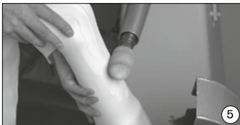
For å tilpasse KF til leggen må inletten monteres og slipes til på de tilsvarende stedene. Evt. må hulrom utjevnes.
