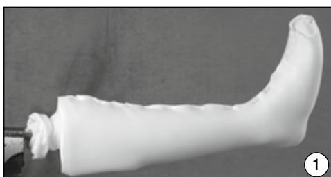
Гипсовую модель обтянуть одним слоем перлонового трикотажного рукава и выполнить вкладыш из педилина (617S3=W5).
