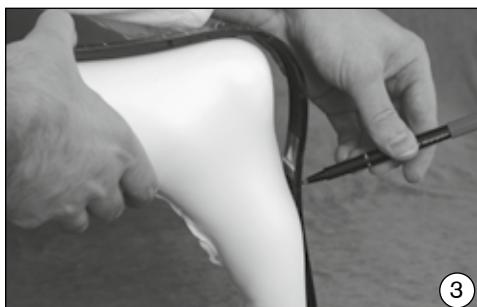
Marcación del resorte de carbono por debajo del pie. La longitud llega hasta unos 20 mm antes de la zona de desarrollo contando desde el hueso del talón. A continuación, determinar la longitud del peroné del resorte. El extremo del resorte de carbono llega hasta 20mm por debajo de la sección de doblado.
