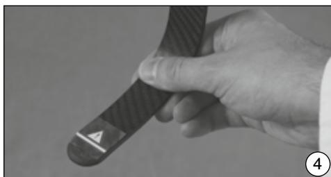
A CF-et maximálisan a jelzésig szabad lerövidíteni, máskülönben lehetetlené válik a rugó biztonságos rögzítése a lábfej-elemben. Simítsák le a vágott széleket.
