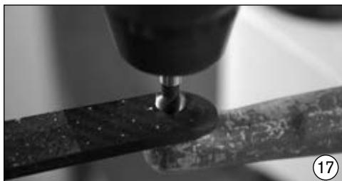
Rebarbar o furo com fresa cónica (726S9=90x11.5) manualmente ou na máquina.
