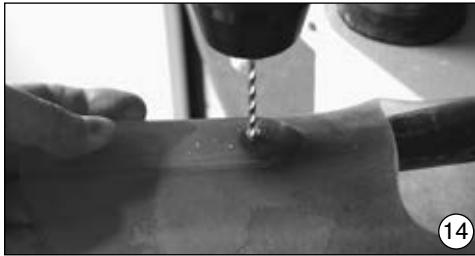
For hullet i polypropylen må man bruke ett 4 mm bor for M4. Ved M5 ett 5 mm bor.
