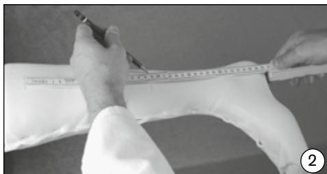
För att fastställa fixerings- och rörelseområdet för karbonfjädern (KF), delas modellen i två delar.
