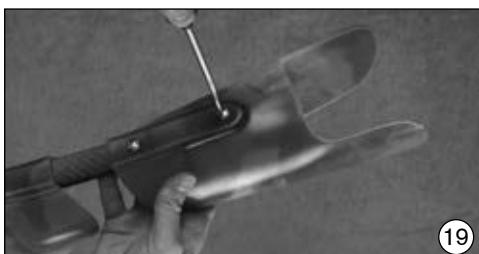
Przykręcić szynę CF dostarczonymi śrubami nierdzewnymi z łączem soczewkowym 501S86 i rozetami 507U9. Rozetki zapobiegają wciśnięciu śrub w głąb polipropylenu i zwiększąją powierzchnię kontaktu.
