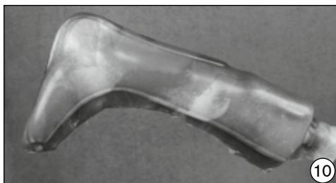
Para embutir en profundidad usar el polipropileno 616T20=2000x4 para todos los tamaños 4 mm. El plástico se tiene que moldear al vacío en el molde.
