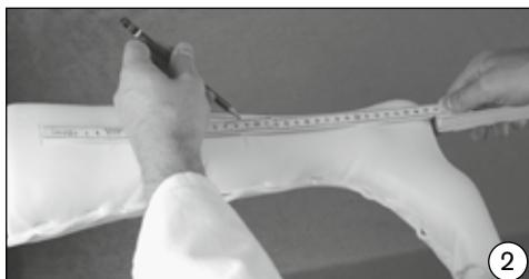
Για να καθορίσετε την περιοχή στερέωσης και κίνησης του ελατηρίου ανθρακονημάτων, διαχωρίστε το πρότυπο σε δύο τμήματα. Μετρήστε τη διάσταση από το άνοιγμα του γόνατος μέχρι το δάπεδο και επισημάνετε το ήμισυ της απόστασης (βλ. σχέδιο 3).
