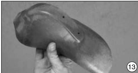
Anzeichnen der Bohrungen auf dem Fußteil.
