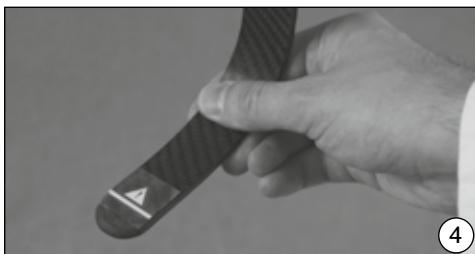
CF se smí zkracovat maximálně až ke značce, protože jinak by ji už nebylo možné v oblasti chodidla spolehlivě zafixovat. Po přířeznutí hrany zaoblete.
