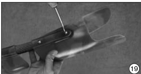
Skruta fast KF med de medlevererade Niro försänkta skruvarna 501S86 och de medlevererade rosettbrickorna 507U9. Rosettbrickorna förhindrar att skruvarna pressas in i polypropylenet och ökar anliggningsytan.
