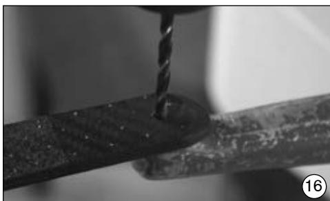
Borra ett 5 mm hål för påsvetsningsmuttern 502E3 (för M4). Använd en 6,5 mm borrh för M5.
