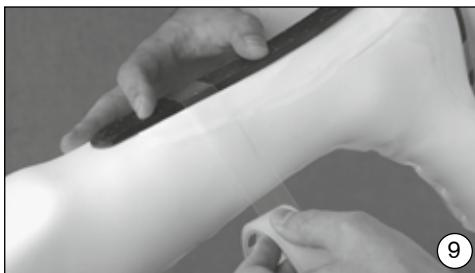
A modell előkészítése a mélyhúzáshoz. Rögzítsek a CF-et a rüszt fölött és a lábikra alatt (627B4) polietilén ragasztószalaggal a modellre. Húzzák egy Perlon trikót a modellre.
