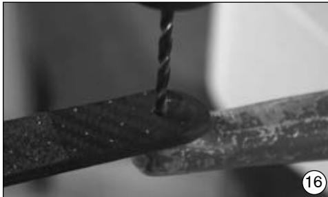
Per il dado per saldatura 502E3, praticare un foro da 5 mm (per M4). Per M5, praticare un foro da 6,5 mm.
