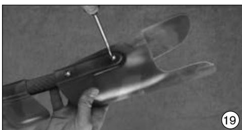
Pomocou skrutiek so šošovkovitou hlavou z nehrdzavejúcej ocele 501S86 zoskrutkujte CF s priloženými miskovitými podložkami 507U9. Miskovité podložky zabráňujú vtláčeniu skrutiek do polypropylénu a zväčšujú dosadaciu plochu.
