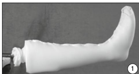
Nałożyć jedną warstwę trykotu perlonowego na model gipsowy i wykonać inlet z materiału „Pedilin” (617S3=W5).
