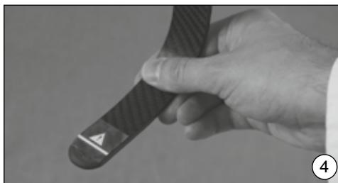
El resorte de carbono puede acortarse como máximo hasta la marca, pues de lo contrario no es posible fijar con seguridad a la pieza del pie. Redondear los cantos de corte.
