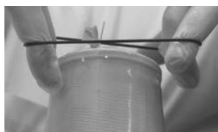
Lamine el vástago. Extienda el anillo de goma y colóquelo sobre el laminado situado debajo del capuchón protector de fundición.
