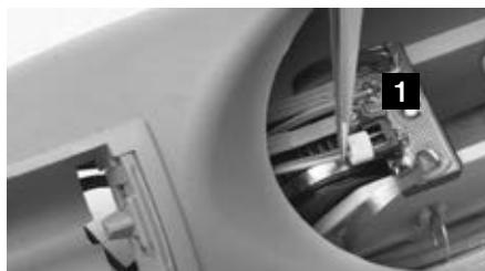
Efter fixering av batteriboxen i underarmen ansluts batterikabeln 13E51=2/4 till kontaktplattan (1) på AFB-enheten.
