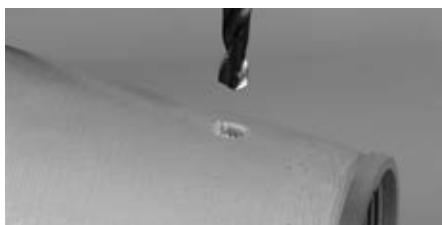
ラミネーションリング直上の上腕骨領域に直径 6mm の穴を 4 つドリルで開けて、湿気が発生した場合に換気できるようにします。
