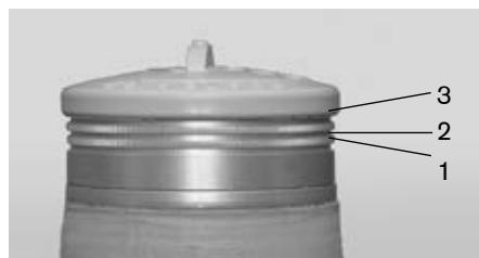
**Remarque:** La bague à couler possède 3 rainures servant à positionner le fil en liant le tricot tubulaire en perlon. Placer le fil pour la première couche du tricot tubulaire en perlon dans la rainure 1. Pour lier les autres couches du tricot tubulaire en perlon, placer le fil dans la rainure 2 et ensuite dans la rainure 3.
