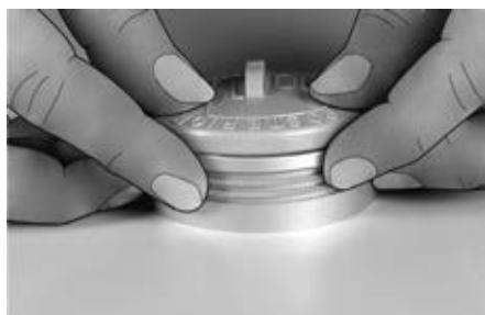
De ingevette ingietdummy over de ingietring schuiven.
