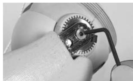
肘継手の 2 本の取付用ネジを外します。
