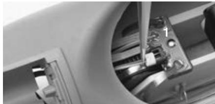
После монтажа крепежной рамки в предплечье подключите соединительный кабель аккумулятора 13E51= 2 / 4 к плате 1 кабеля предплечья. (Плата крепится на вспомогательном узле сгиба.)
