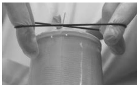
Laminera hylsan. Töj ut gummiringen och placera den över det ännu varma laminatelet under det ingjutna skyddslocket.
