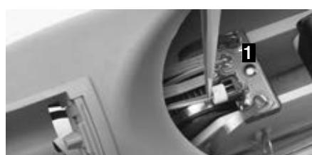
バッテリーを配置したら、前腕ケーブルの回路基板 [1] にバッテリー接続用ケーブル 13E51=2/4 を押し込んでください。(回路基板は AFB に取り付けられています。)
