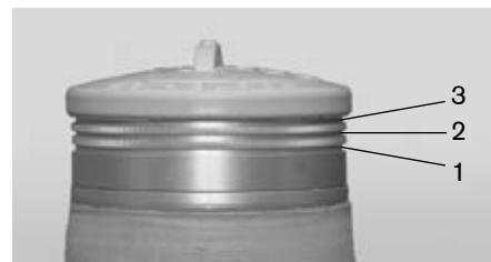
**Hinweis:** Der Eingussring besitzt 3 Rillen zur Aufnahme der Schnur beim Abbinden des Perlontrikotschlauches. Die Schnur für die erste Perlontrikotschlauch-Lage in Rille 1 einlegen. Zum Abbinden weiterer Lagen Perlontrikotschlauch, Schnur in Rille 2 und danach in Rille 3 einlegen.
