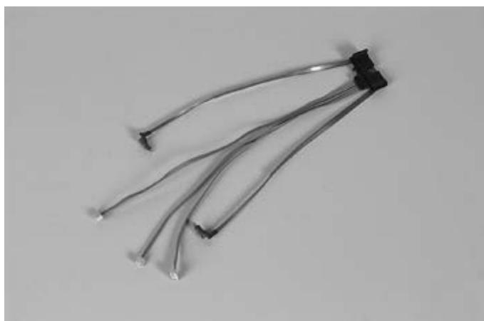
Underarmkabel att clipsa på flexionshjälp AFB. Den utgör den elektriska förbindelsen mellan armbågsled och System-Elektrohand resp. System-Elektrorgreifer.
