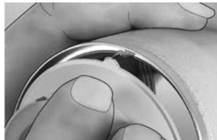
電子部品と絶縁ワイヤーを、ラミネーションリングの中にしっかりと押し込みます。
