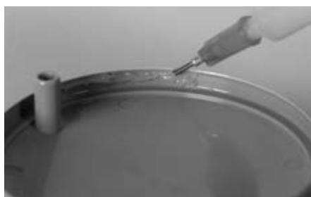
Garnir le bord de la protection de lamination avec la graisse spéciale 633F30.
