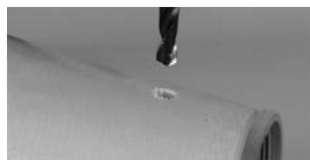
4 Bohrungen mit 6 mm Durchmesser im Oberarm kurz über dem Eingussring anbringen, damit möglicherweise beim Schwitzen des Patienten eindringende Feuchtigkeit verdunsten kann.
