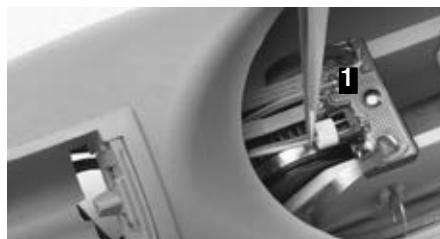
Après avoir placé le cadre de mise en place dans l'avant-bras, brancher le câble de l'accumulateur 13E51=2/4 sur la platine 1. (La platine est fixée sur le système d'aide à la flexion)
