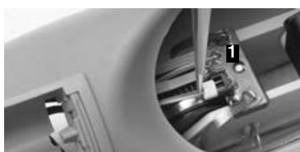
Después de montar el antebrazo el marco de introducción 3E51=2/4, conectar a la pletina 1 del cable del antebrazo el cable de conexión para el acumulador. (La pletina se encuentra fijada al automático.)
