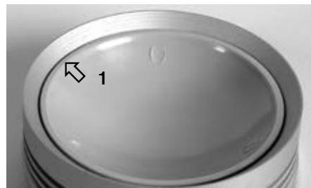
Lamineringsskyddet 1 har fixerats i rätt position. Avståndet mellan kanterna är jämnt runt om.
