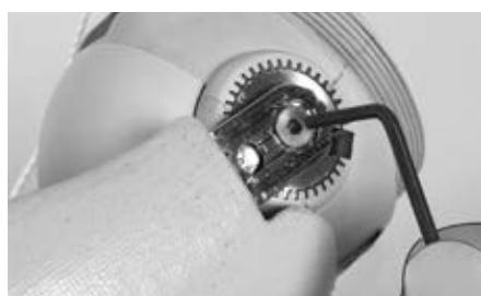
Avlägsna de bågge fixeringsskruvarna ur leden.
