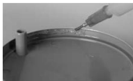
Смажьте кромку защитной крышки специальной консистентной смазкой 633F30.
