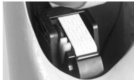
注:AFB 屈曲補正機構を正しく機能させるためには、肘継手が完全に伸展する際にはバンドカムが伸展ストップに達している必要があります。
