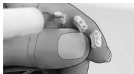
Niet gebruikte blinde stekker uit de elektronische behuizing trekken. De overeenkomstige kabel bij de stekker goed met siliconenvet 633F11 invetten.
