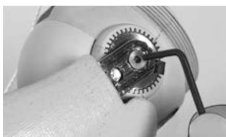
De twee bevestigingsschroeven van het elleboogscharnier eruit draaien.
