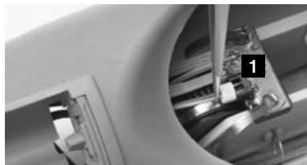
Na het inbouwen van de accuhouder in de onderarm, de aansluitkabel 13E51=2/4 aan de printplaat 1 van de onderarmkabel steken. (De printplaat is aan de buighulp bevestigd.)
