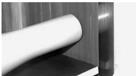
Underarmen kortas till lämplig längd genom kapning och slipning.
