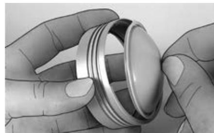
Inserite la calotta lubrificata nell'anello di colata ingrassato, premendo bene.
