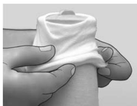
Eche para atrás la manguera de tejido de perlón y recubra el vástago con la misma de modo que esté tirante. Repita el procedimiento con las siguientes capas y ate la manguera de tejido de perlón en la ranura 2 y 3 del anillo de relleno.
