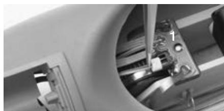
Nach Einbau des Einlegrahmens in den Unterarm, das Akkuanschlusskabel 13E51=2/4 an der Platine 1 des Unterarmkabels anstecken. (Die Platine ist an der Beugehilfe befestigt.)
