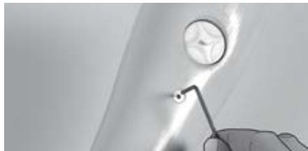
Die beiden Befestigungsschrauben am Unterarm herausdrehen.
