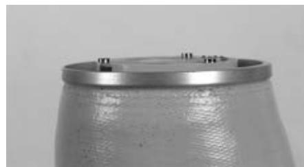
La platine et le bord de la bague à couler se trouvent sur le même plan.
