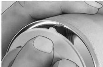
Inserite l'alloggiamento dell'elettronica con i cavi infilati nell'anello di colata lubrificato, premendo **bene**.
