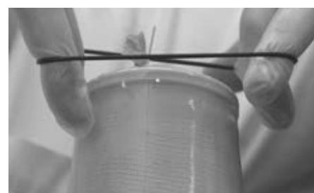
ソケットのラミネーションを行ないます。ゴム製リングを伸ばして、ラミネーション保護カバーの下のまだ固まっていないレジンの周囲に置きます。
