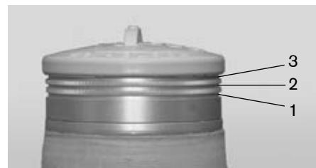
**Aanwijzing:** in de ingietring zitten 3 groeven waarin het snoer gelegd moet worden waarmee de perlontricotslang wordt vastgebonden. Leg het snoer voor de eerste laag van de perlontricotslang in groef 1. Leg het snoer waarmee de volgende lagen perlontricotslang worden vastgebonden, in de groeven 2 en 3.
