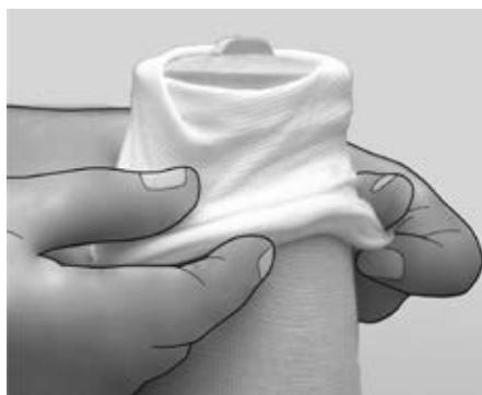
Sla de perlontricotslang terug en trek de slang strak over de schacht. Herhaal dit voor de volgende lagen en bind de perlontricotslang daarbij achtereenvolgens vast in de groeven 2 en 3 van de ingietring.
