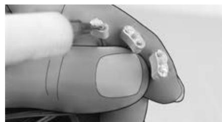
Nicht benötigte Blindstecker aus dem Elektronikgehäuse ziehen. Die entsprechenden Kabel am Stecker gut mit Silikonfett 633F11 fetten.
