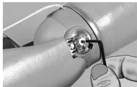
Mettre du Loctite 243 sur les deux vis de fixation de l'articulation du coude et serrer à fond **de manière uniforme**.
