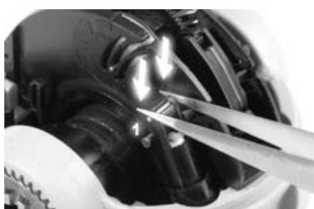
...y encajar en el eje metálico sobresaliente 1.
