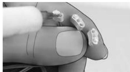
Retirer du boîtier électronique les fiches isolantes qui ne sont pas nécessaires. Bien graisser, sur la fiche mâle, les câbles correspondants à l'aide de graisse de silicone 633F11.
