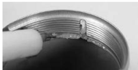
De groef en de binnenkant van de ingietring met specialvet 633F30 invetten..
