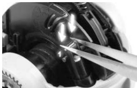
突出した金属軸の上にパチッと止めます [1]。ボールキャップを戻して被せます。
