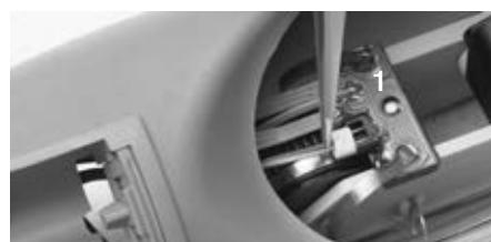
Dopo il montaggio dell'alloggiamento per accumulatore nell'avambraccio, infilate il cavo di collegamento dell'accumulatore 13E51=2/4 alla piastrina 1 del cavo dell'avambraccio (la piastrina è fissata al dispositivo di flessione).
