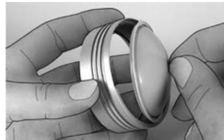
グリースを塗ったエルボーカバーを、同じくグリースを塗ったラミネーションリングに挿入してしっかりと押し込みます。パチッと閉まる音がするまでしっかりとカバーを挿入してください。
