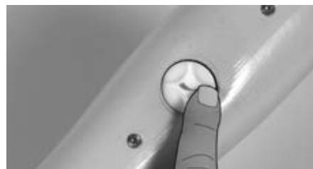
Met het handwiel kan de compensatiekracht worden ingesteld en aan het gewicht van uiteenlopende kleding worden aangepast.
