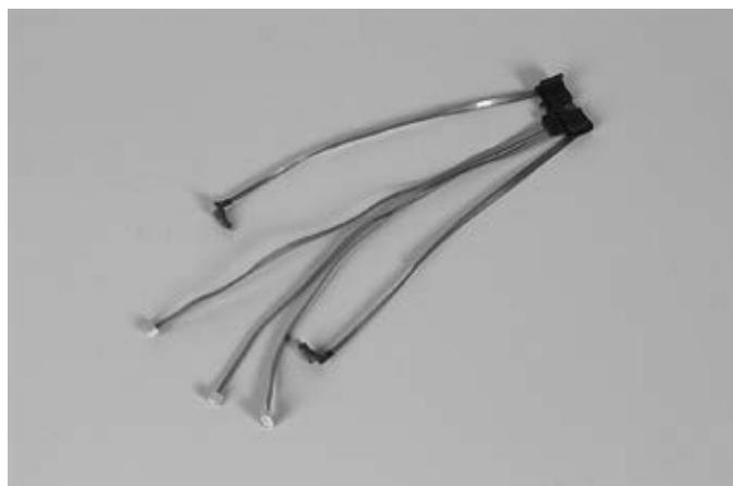
Onderarmkabel om op het beugelhulpstuk AFB vast te klemmen. Deze brengt de elektrische koppeling tot stand tussen het ellebooggewicht en de syssteem-elektrohand resp. de systeem-elektrogrijper.
