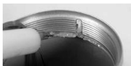
Après le laminage, enlever toute trace de graisse et de salissure éventuelle de la bague à couler. Graisser la rainure et le bord intérieur de la bague, ainsi que le filetage, à l'aide de graisse spéciale 633F30.
