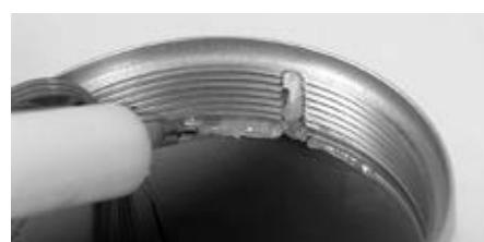
Na het lamineren het siliconenvet en mogelijk vuil wegnemen. De groef en de binnenrand evenals de Schroefdraad van de ingietring met specialvet 633F30 invetten.
