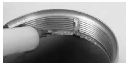
Nut und innenliegende Kante des Eingussringes mit Spezialfett 633F30 fetten.
