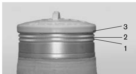
**Indicación:** El anillo de relleno posee 3 ranuras para alojar la cuerda que ata la manguera de tejido de perlón. Inserte la primera cuerda de la capa de mangueras de tejido de perlón-en la ranura 1. Inserte después la cuerda en la ranura 2 y luego en la 3 para atar capas adicionales de la manguera de tejido de perlón.
