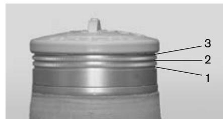
**Avviso:** l'anello di colata evidenzia 3 solchi destinati ad accogliere il filo nel fissare la maglia tubolare. Sistemate il filo per il primo strato di maglia tubolare nel solco 1. Per fissare ulteriori strati di maglia tubolare sistemate il filo nei solchi 2 e quindi 3.
