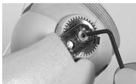
Выверните оба крепежных винта локтевого шарнира.
