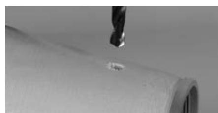
Praticate 4 fori con diametro 6 mm nel prefabbricato di braccio, poco sopra l'anello di colata, in modo da permettere l'evaporazione del sudore che potrebbe penetrare.
