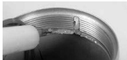
По завершении ламинации очистите закладное кольцо от консистентной смазки и возможных загрязнений. Смажьте паз, внутреннюю кромку и резьбу закладного кольца специальной консистентной смазкой 633F30.
