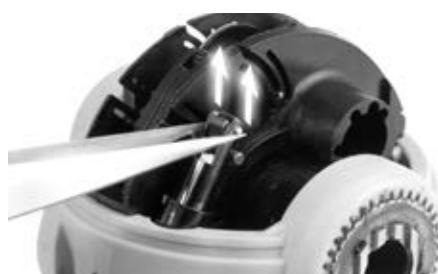
Disinserite con cautela il telescopio a molla.
