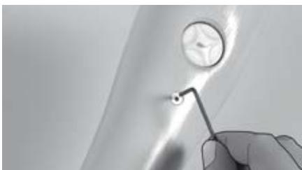
Serrer à fond les vis de fixation de l'avant-bras.
