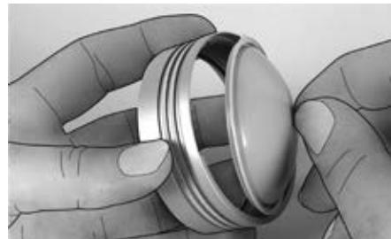
Ingevette halfronde schaal in de ingevette ingietring aanbrengen en **vast** aandrukken.
