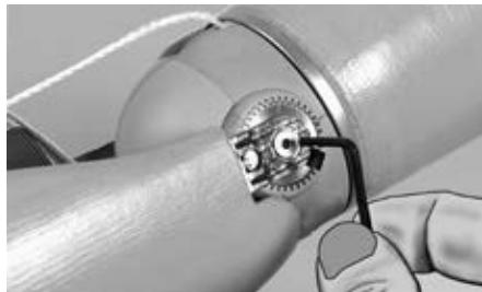
Нанесите клей Loctite 243 на крепежные винты локтевого шарнира и **равномерно** затяните.
