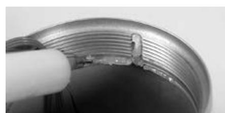
Nach dem Laminieren den Eingussring von Fett und eventuellem Schmutz reinigen. Nut und innenliegende Kante sowie das Gewinde des Eingussringes mit Spezialfett 633F30 fetten.
