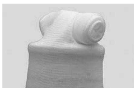
Couper le tricot tubulaire en perlon d'une double longueur de l'emboîture. Tourner l'intérieur du tuyau en tricot de perlon vers l'extérieur, l'étirer au-dessus de l'emboîture et enrouler.
