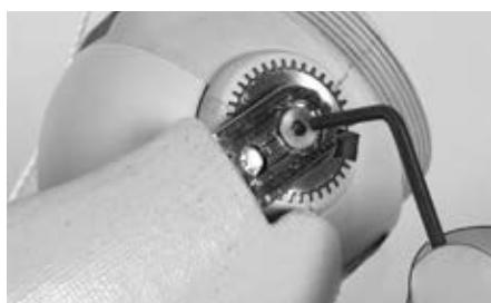
Svitate le due viti di fissaggio del gomito.
