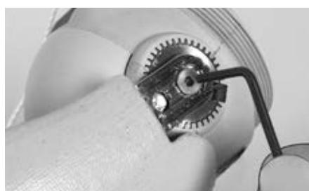
Soltar los dos tornillos de fijación de la articulación del codo. Extraer la articulación de codo.
