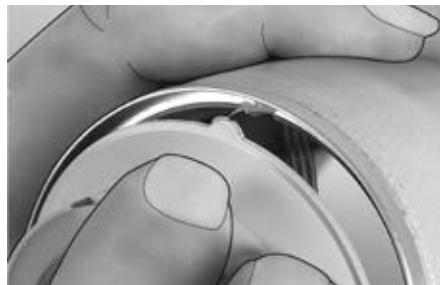
Introducir la carcasa con los componentes electrónicos y los cables conectados en la anilla engrasada y presionar **fuertemente**.
