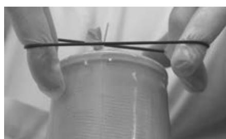
Laminer l'emboîture. Étirer l'anneau en caoutchouc et l'appliquer sur l'aggloméré laminé encore mou sous la protection du moule.
