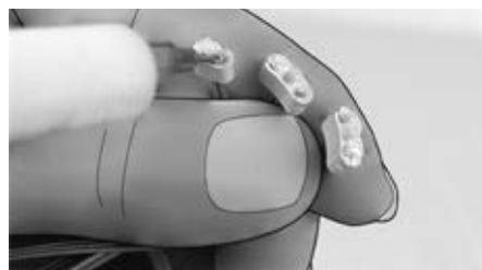
Вытяните ненужные холостые штекеры из корпуса блока электроники. Хорошо смажьте соответствующие кабели на штекере силиконовой смазкой 633F11.
