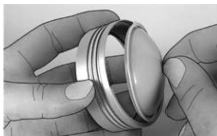
Faire glisser la demi-coque dans la bague à couler graissée, et l'y enfoncez **fermement**.
