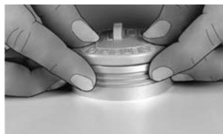
グリースを塗ったラミネーション保護カバーをラミネーションリングの上から押し込みます。パチッと閉まる音がするまでカバーを溝に挿入して固定してください。
