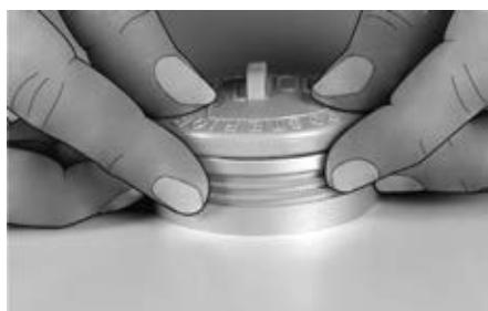
Une fois graissée, faire glisser la protection du moule par-dessus la bague à couler.
