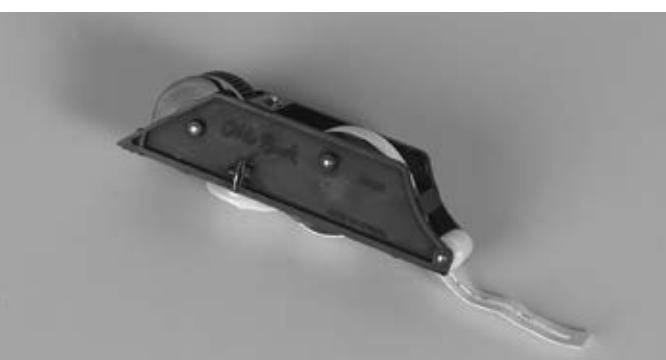
義肢を伸展させると、生み出されたエネルギーが AFB に蓄えられ、そのエネルギーを使って、より簡単に屈曲できます。AFB は複雑なメカニズムで前腕義肢の動的動作を制御し、補正ギアを介して前腕やリストユニット、端末の重量のバランスを取ります。継手を屈曲させるために装着者が生み出さなくてはならない力が劇的に少なくてすみます。補正量は、前腕義肢の重量と布類の種類に応じて、装着者が必要な時に簡単に調整できます。
