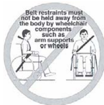
Colocación incorrecta de los cinturones de los ocupantes
