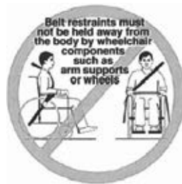
Falsche Positionierung der Gurte am Insassen
