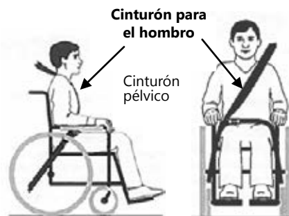
Colocación adecuada de los cinturones de los ocupantes
